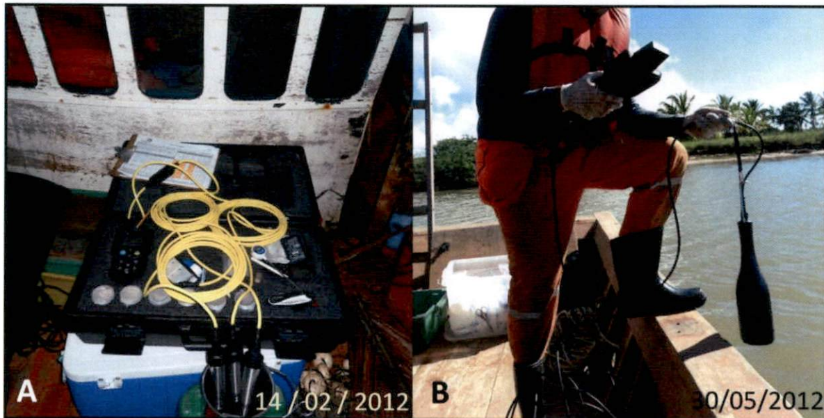
Figura II.2.2.1-1 - Medição da temperatura, condutividade elétrica, salinidade, pH e oxigênio dissolvido em campo – Campanhas de Fevereiro/2012 (A) e Maio/2012 (B).
