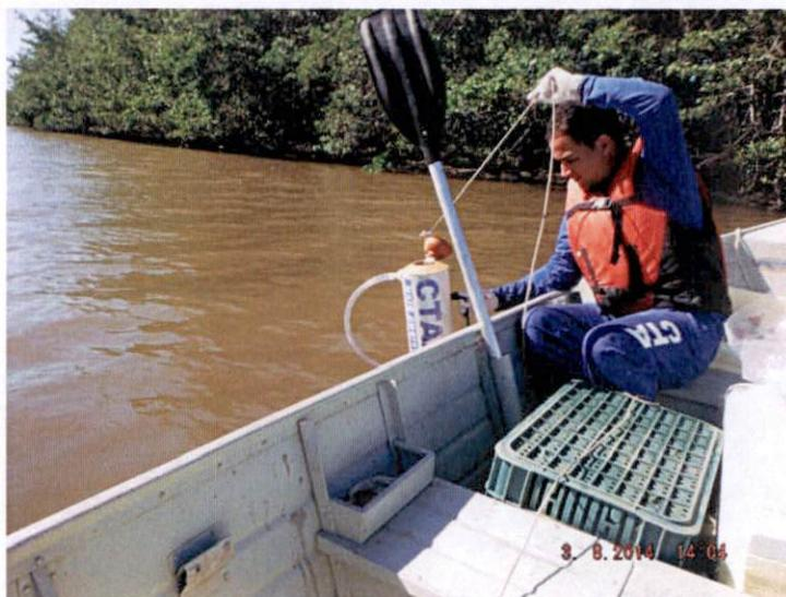
Figura 6-1: Coleta de água com a garrafa de Van Dorn.
