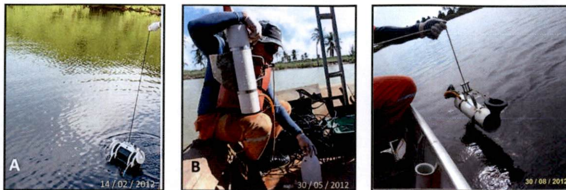
Figura II.2.1-2 – Coleta de água com auxílio de Garrafa Van Dorn – Campanhas de Fevereiro/2012 (A), Maio/2012 (B) e Agosto/2012 (C).
