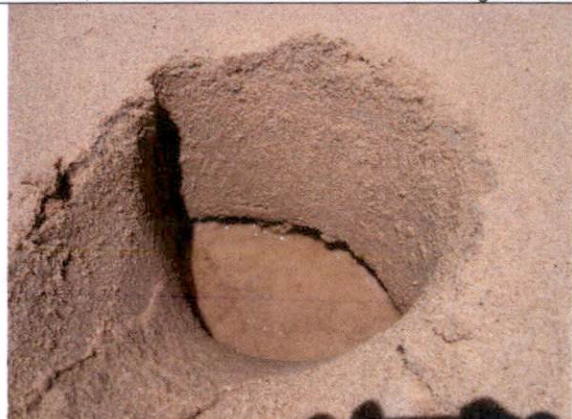
Foto - 49 - Cavas para identificação de substâncias oleosas, cavas estas realizadas na boca da lagoa.
