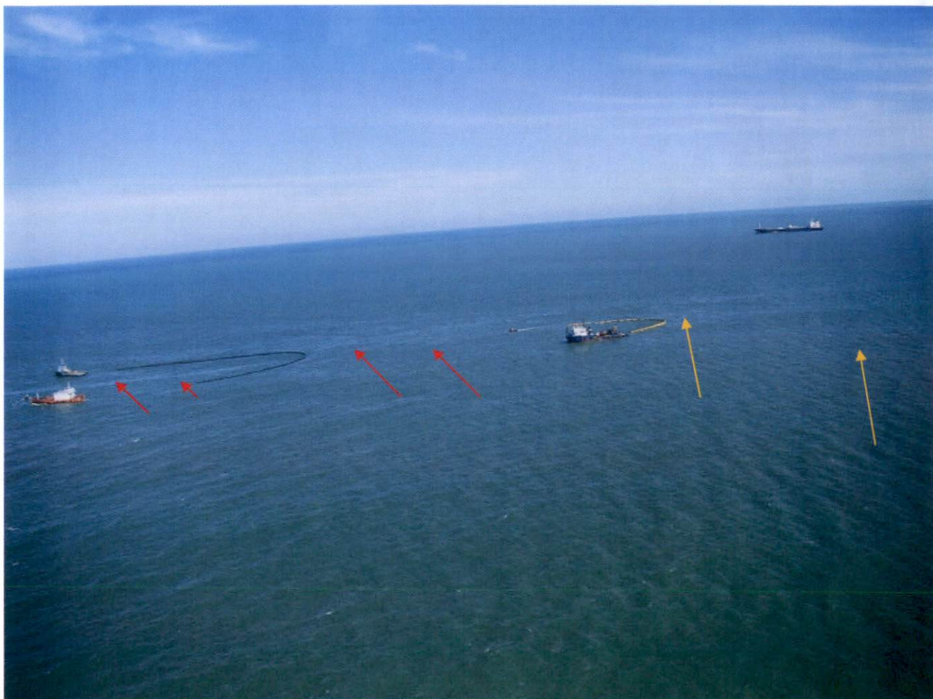
Foto 14. Vista das embarcações próximas à monobóia, realizando o cerco do filme de óleo (setas vermelhas) que ainda saía da linha de mangotes da monobóia. Detalhe da mancha se dispersando no ambiente apesar do cerco (setas amarelas).
