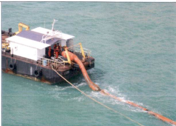
Foto - 34 - Procedimento para retirada do Petróleo contido dentro da tubulação da bóia.
