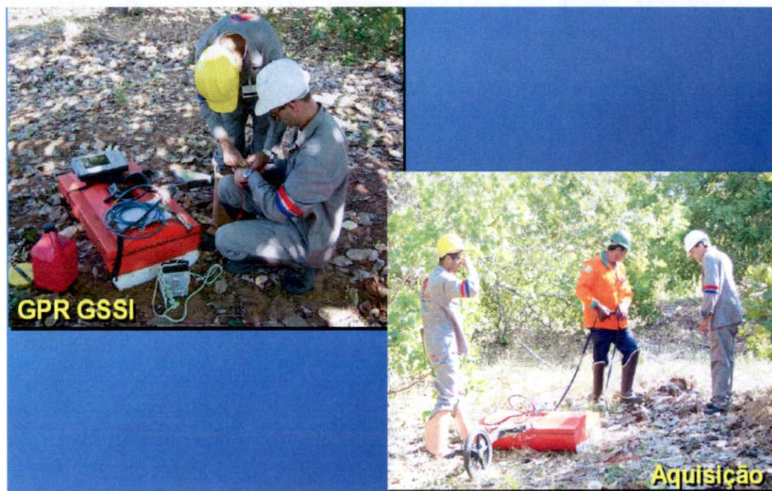
Fig. 04 - Equipe trabalhando no Caminho de passagem com o GPR.
