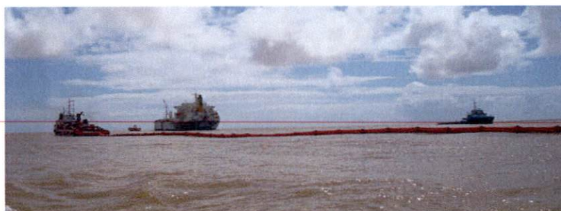
Imagem de lançamento de barreira de contenção por ORV na monoboia do TNC
