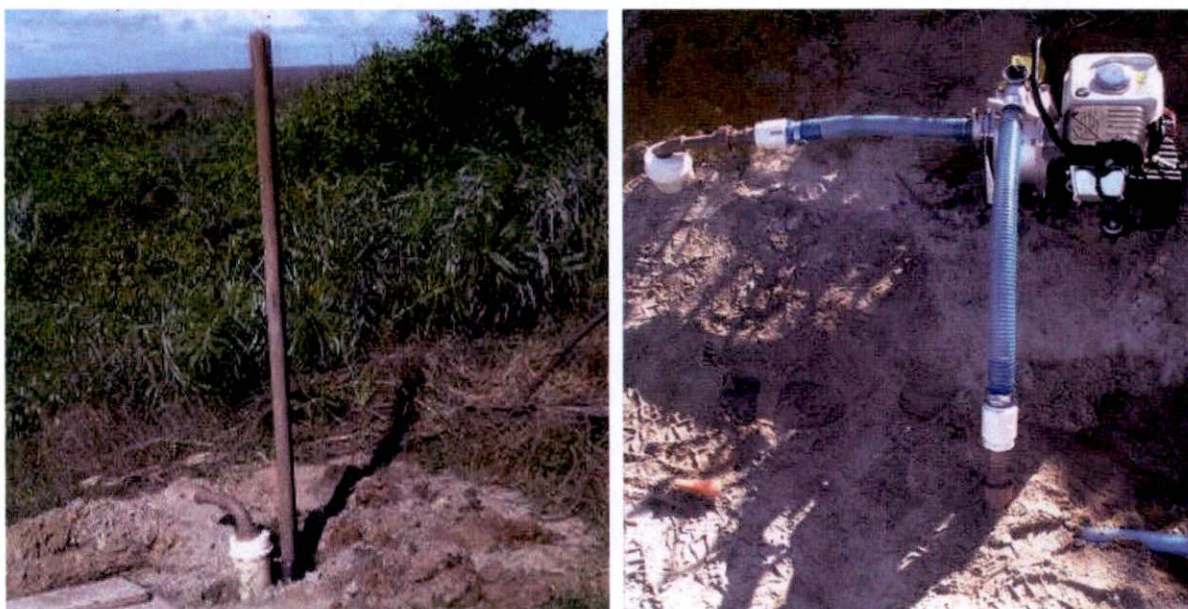
Figura 6: Poço na área da recomposição vegetal na orla de Guriri e Motobomba utilizada no sistema de irrigação
