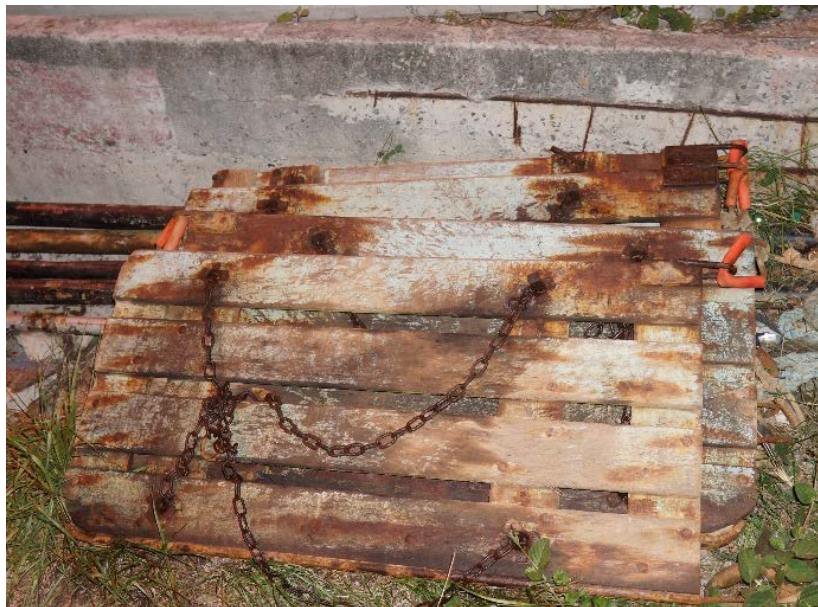
Figura 6-3: Estrutura da porta da pesca com Rede de arrasto.
