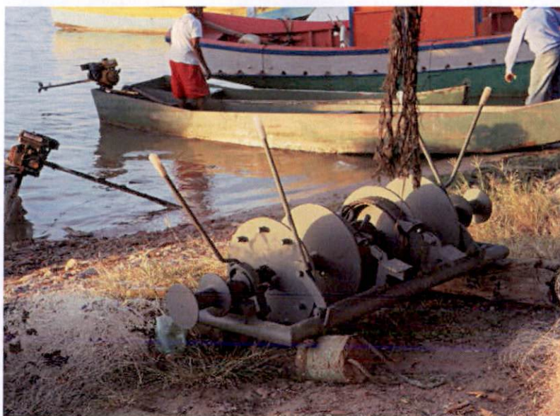
Figura 6-2: Estrutura do guincho da pesca com Rede de arrasto.
