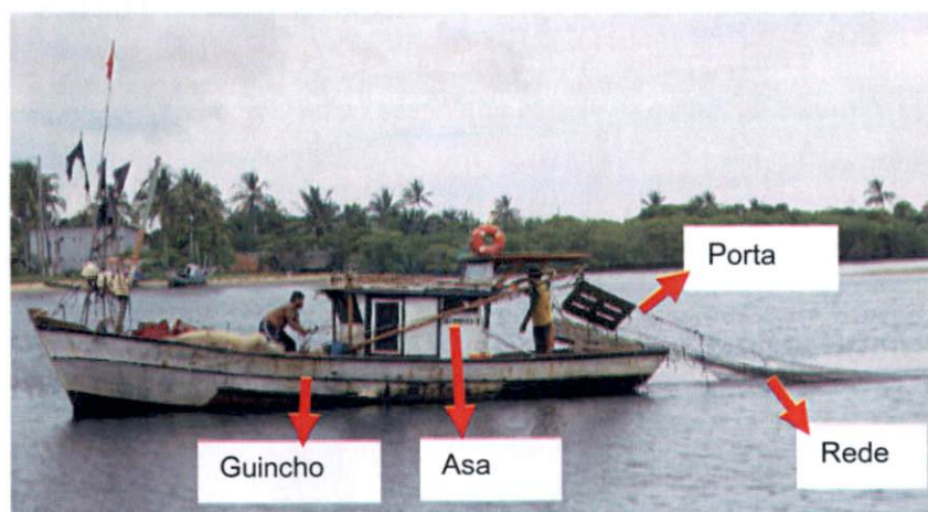
Figura 6-1: Estruturas da pesca de Rede de arrasto.
