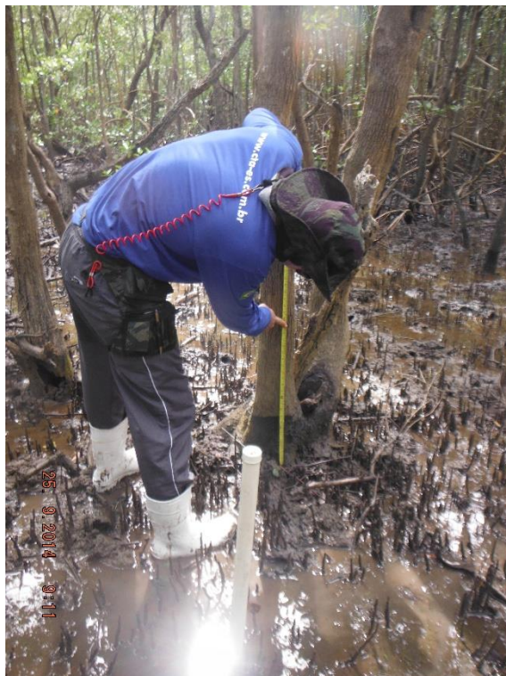
Figura 3-2: Estimativa de inundação da maré com base na altura de algas incrustadas nos manguezais.
