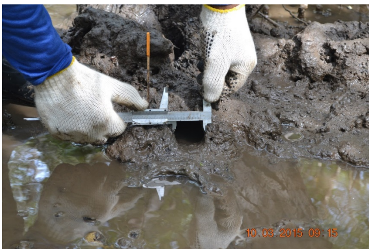
Figura 3-2: Técnico em campo aferindo diâmetro de galeria de caranguejo com auxílio de um paquímetro em aço inoxidável.
