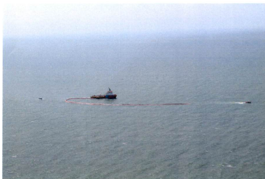
COMBATE À POLUIÇÃO – CERCO DA MANCHA E RECOLHIMENTO
