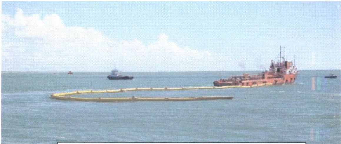
COMBATE À POLUIÇÃO – CERCO DA MANCHA E RECOLHIMENTO
