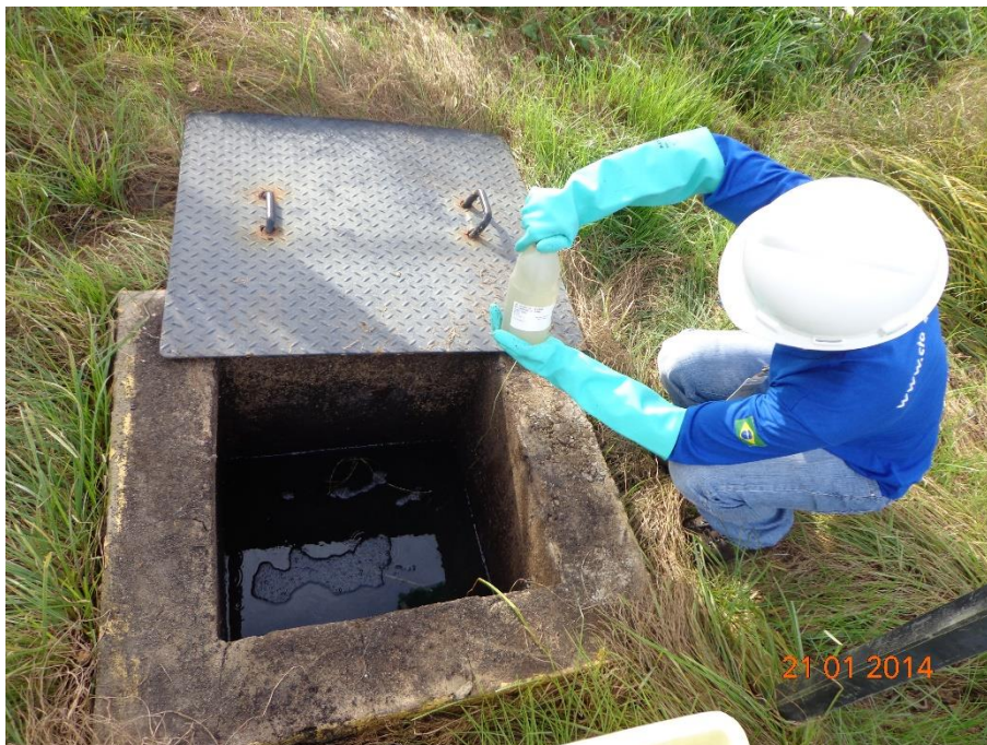
Figura 5-2: Demonstração de coleta do efluente tratado na Saída da ETE com frascos apropriados para análise laboratorial.
