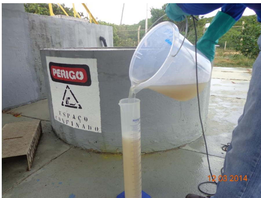
Figura 5-1: Demonstração de coleta de efluente com auxílio de corda, balde e proveta.
