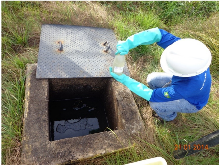
Figura 6-4: Demonstração de coleta do efluente tratado na Saída da ETE com frascos apropriados para análise laboratorial.
