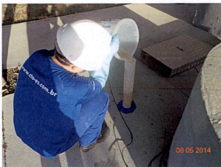
Figura 6-3: Medição de vazão na elevatória da ETE (Entrada) com auxílio de corda e balde.
