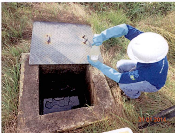
Figura 6-2: Demonstração de coleta do efluente tratado na Saída da ETE com frascos apropriados para análise laboratorial.
