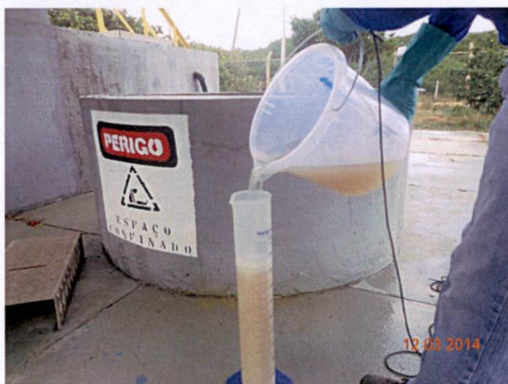
Figura 6-1: Demonstração de coleta de efluente com auxílio de corda, balde e proveta.
