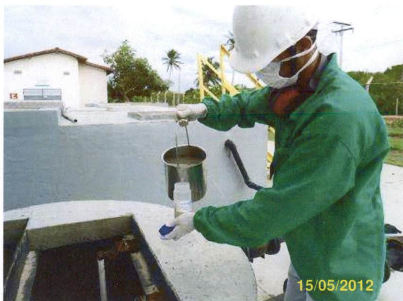
Figura 4 - Processo de coleta e amostragem da ETE
