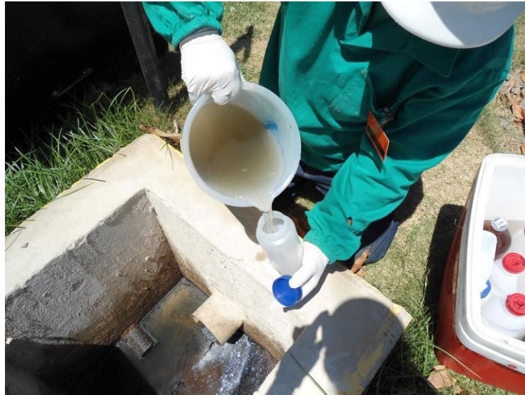
Figura 8 - Coleta na saída da Estação de tratamento de efluentes.
