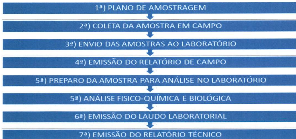
Figura 6 - Procedimentos operacionais de monitoramento da água da ETE – TNC
