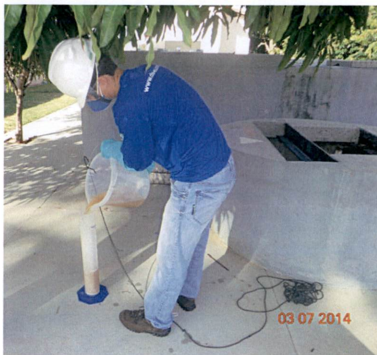
Figura 5-1: Coleta de efluente com auxílio de corda, balde e proveta.
