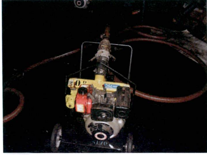
Balsa Hydra Port – Limpeza interna dos mangotes com bomba diafragma
