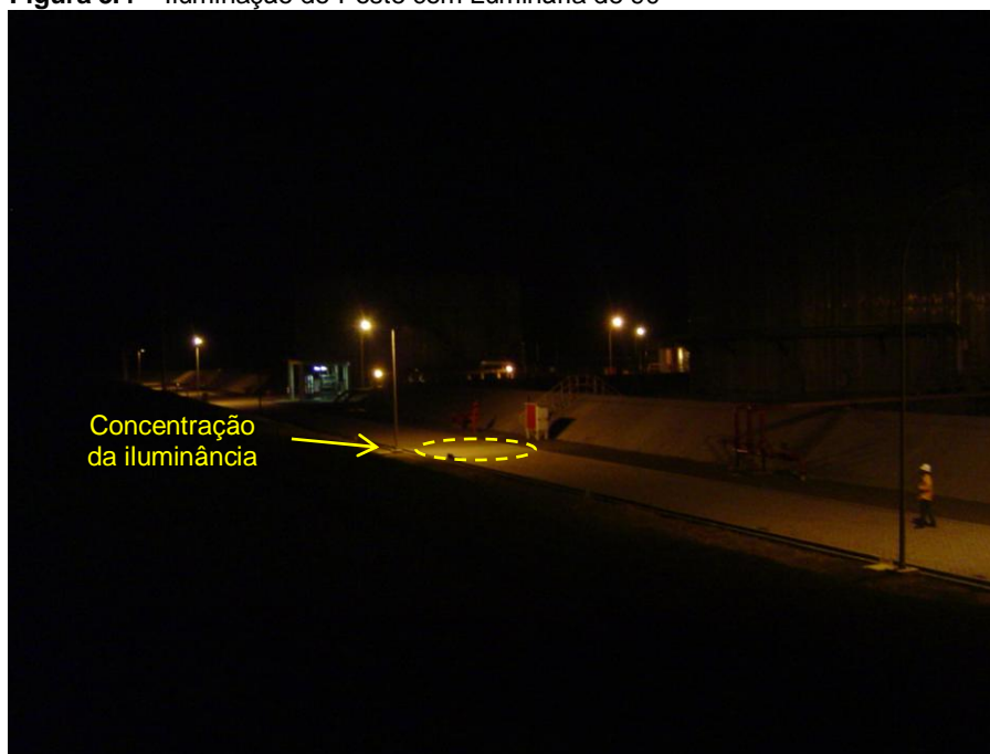
Figura 5.4 – Iluminação do Poste com Luminária de 90°
