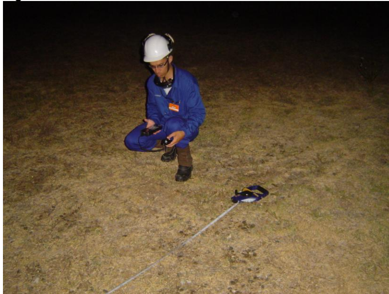
Figura 5.5 – Monitoramento da Iluminância na Área Interna do TNC
