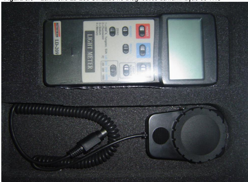
Figura 3.6 – Luxímetro LD 209 Utilizado no Diagnóstico da Iluminação do TNC
