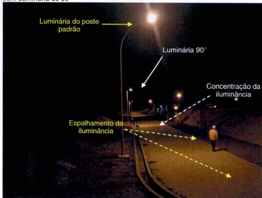
Figura 5.3 – Diferenças da Iluminação Provocada Pelo Poste Padrão e Pelo Poste com Luminária de 90°
