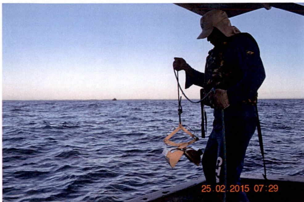
Figura 4-1: Demonstração da coleta de sedimento com draga de Petersen , durante campanha de fevereiro/2015.
