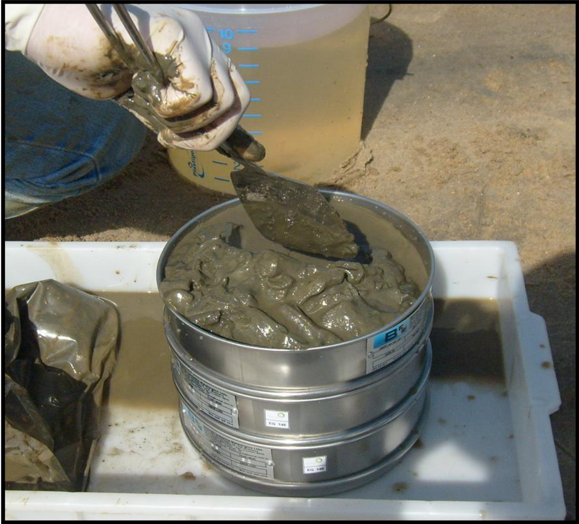
Figura V.3.2: Sedimento estuarino sendo peneirado para eliminação de frações granulométricas menores que 0,5mm.
