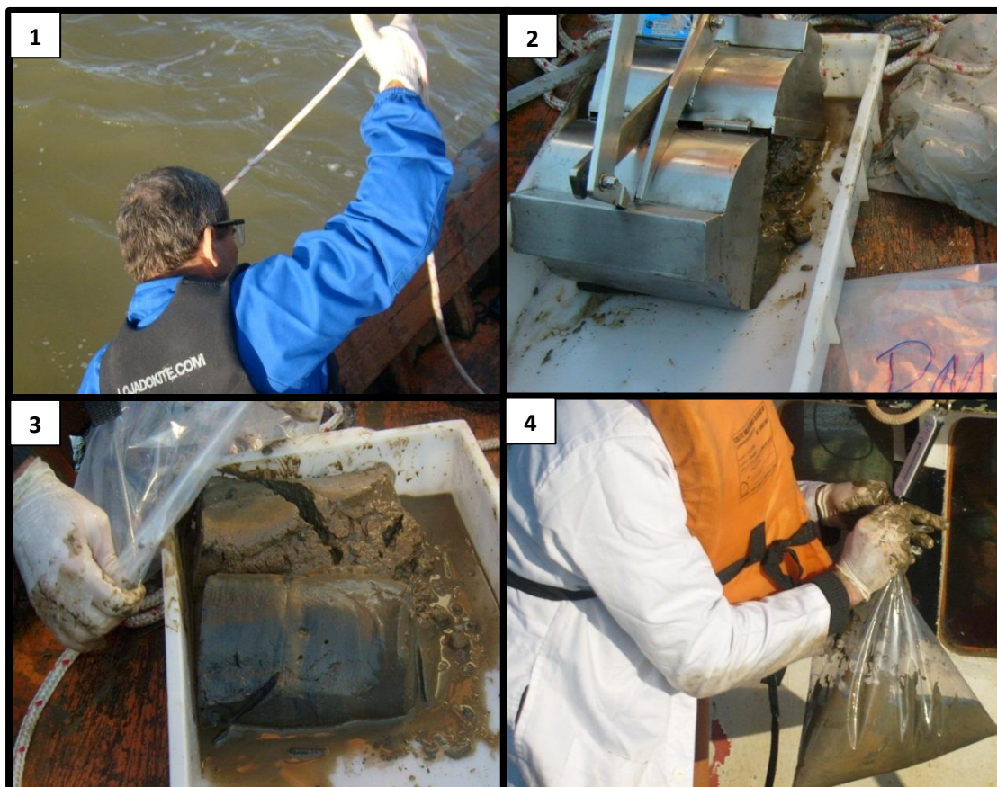
Figura V.3.1: Sequência enumerada em ordem crescente o procedimento de coleta de sedimento com a Draga de Petersen, utilizado para todos os pontos amostrais.
