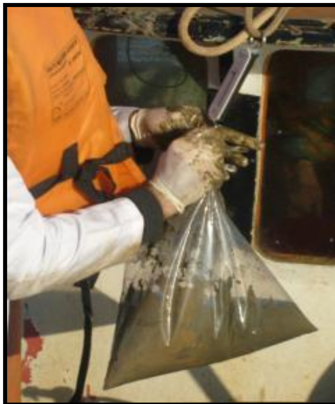
Figura 7 – Pesagem das amostras de sedimento com auxílio de um dinamômetro.
