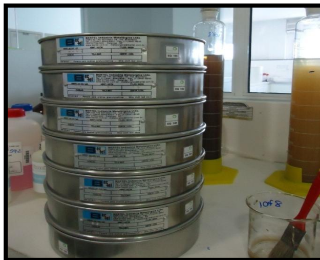
Figura V.2.1: Conjunto de peneiras utilizadas durante análise granulométrica.
