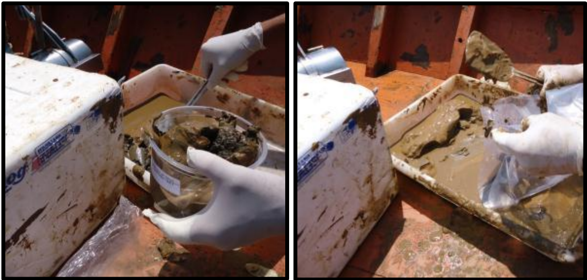
Figura 6 - Materiais utilizados na coleta de sedimento marinho e estuarino.
