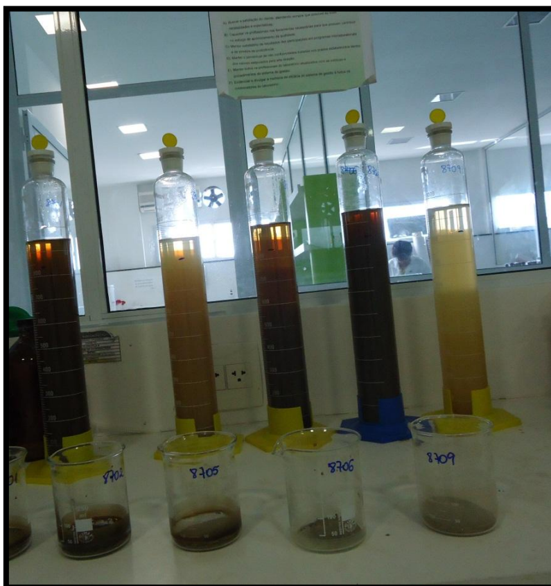
Figura V.2.2: Procedimento de determinação do tempo de sedimentação das amostras e retirada da fração fina com água destilada.
