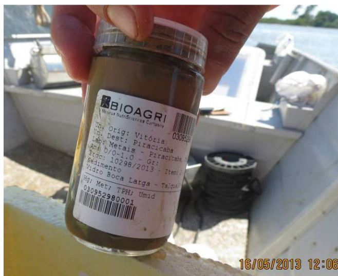
Figura III.2.2-3: Material coletado acondicionado em recipiente para análise de metais pesados e HTP Finger Print.
