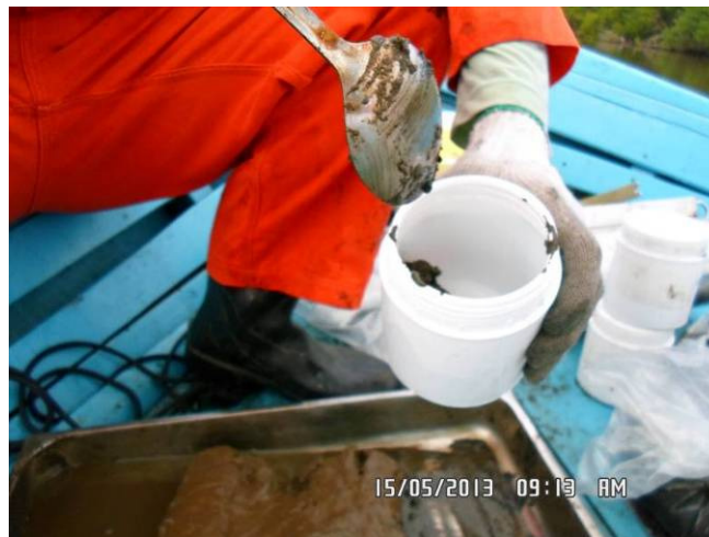
Figura III.2.2-2: Acondicionamento de material coletado em recipiente para análise de granulometria.
