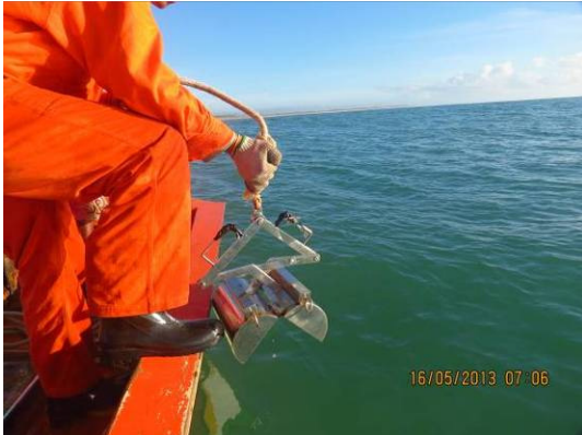
Figura III.2.2-1: Coleta de sedimentos com o amostrador do tipo busca fundo de Petersen.
