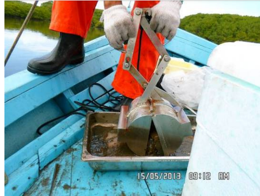
Figura III.2.2-1: Coleta de sedimentos com o amostrador do tipo busca fundo de Petersen.
