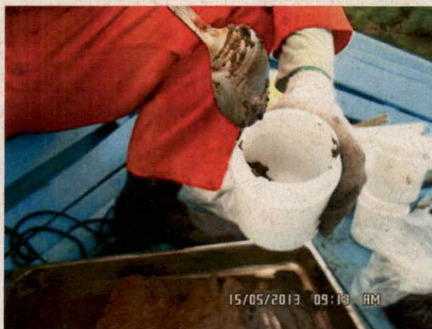
Figura III.2.2-2: Acondicionamento de material coletado em recipiente para análise de granulometria.
