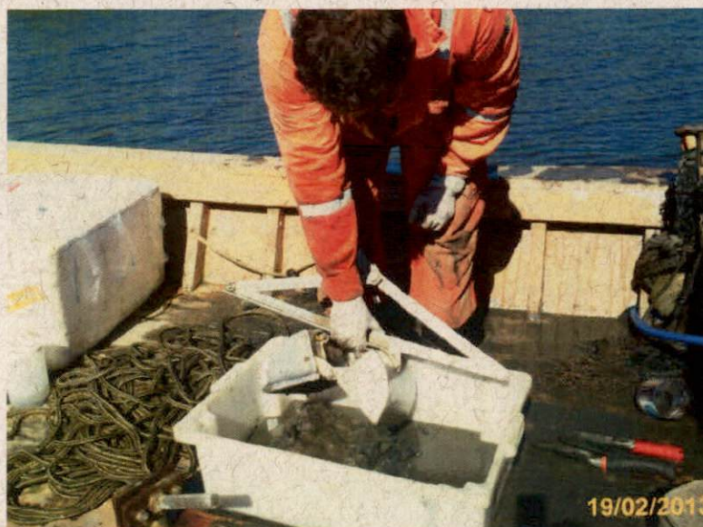
Figura III.3.1-2: Coleta de sedimento com draga de Van Venn.
