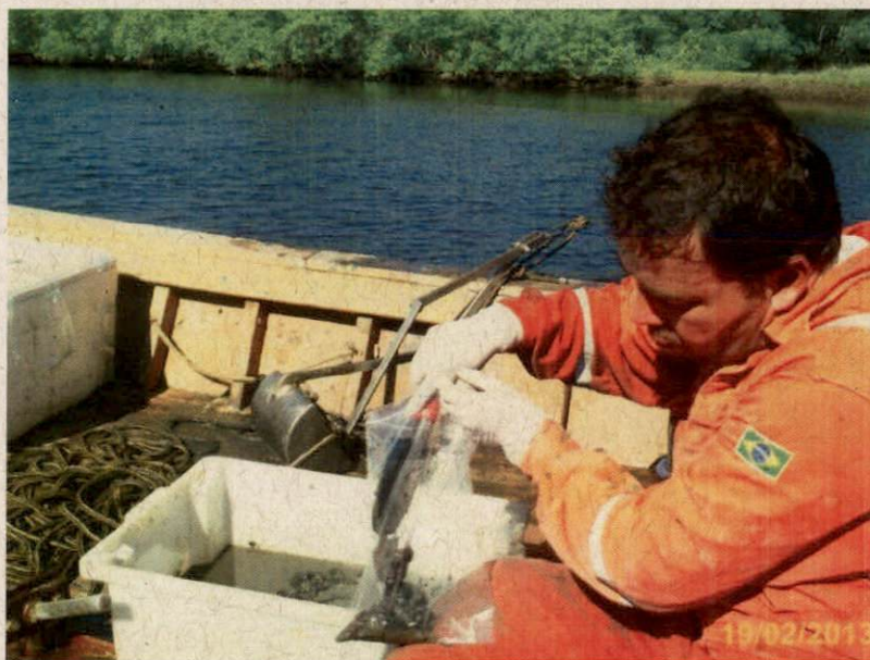
Figura III.2.1-1: Coleta de sedimento em ponto estuarino para análise de granulometria
