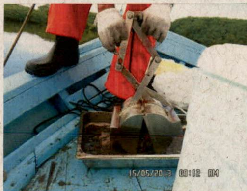
Figura III.2.2-1: Coleta de sedimentos com o amostrador do tipo busca fundo de Petersen.
