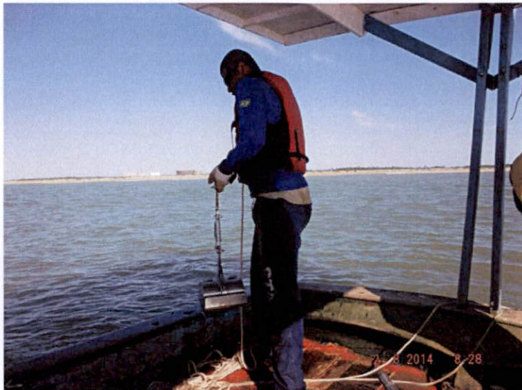
Figura 4-1: Demonstração da coleta de sedimento com draga de Petersen , durante campanha de agosto/2014.
