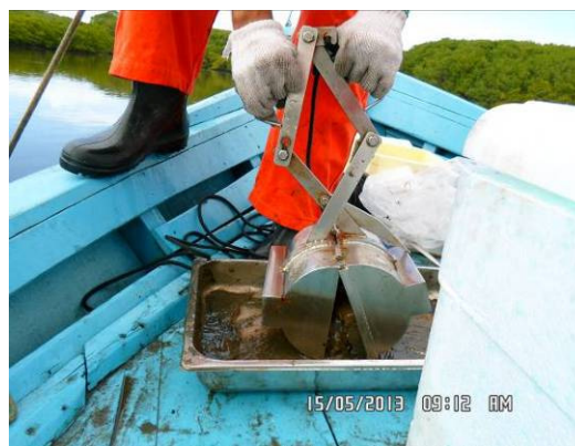
Figura III.2-4: Coleta de sedimentos com o amostrador do tipo Van Venn.
