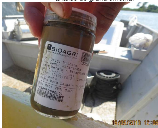
Figura III.2-6: Material coletado acondicionado em recipiente para análise de metais pesados e HTP Finger Print.
