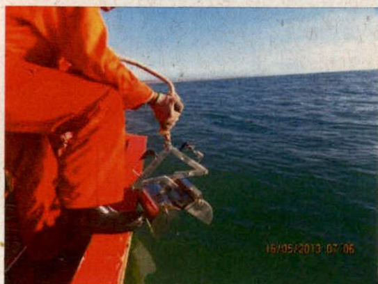
Figura III.2-4: Coleta de sedimentos com o amostrador do tipo Van Venn.
