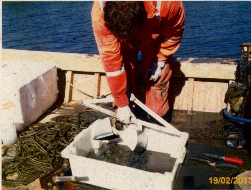
Figura III.3-2: Coleta de sedimento com draga de Van Venn.
