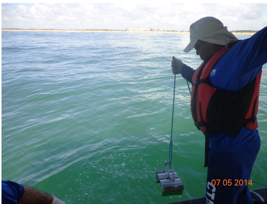
Figura 4-1: Demonstração da coleta de sedimento com draga de Petersen , durante campanha de fevereiro de 2014.
