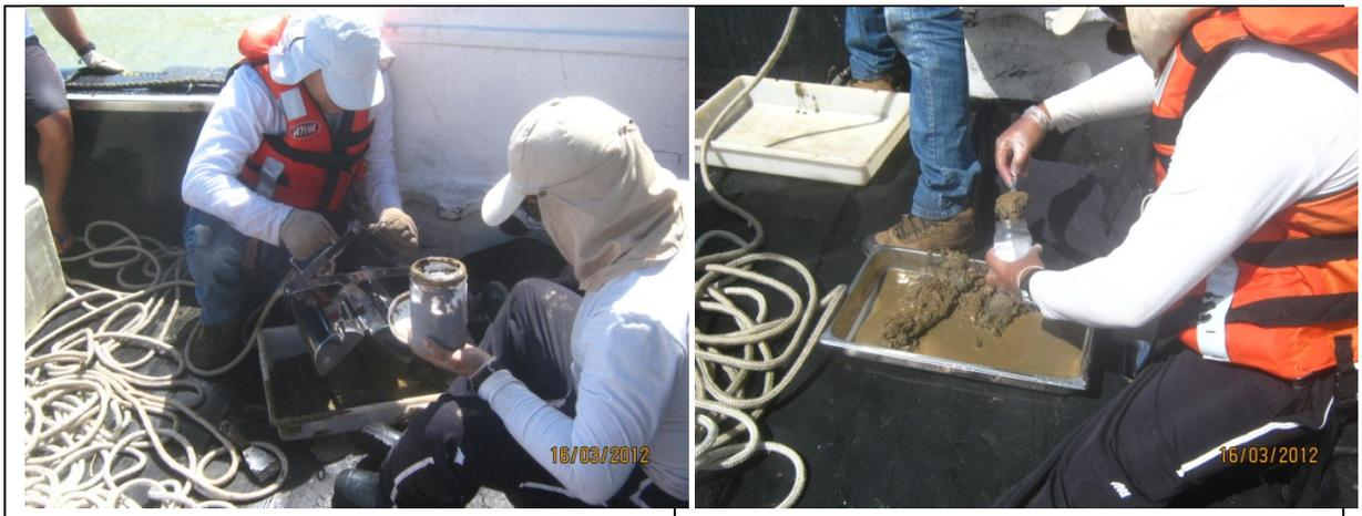
**Figura IV.3.1 - 1** – Coleta do sedimento com a draga tipo Petersen e acondicionamento do material coletado em frascos.
