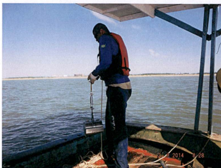
Figura 6-1: Demonstração da coleta de sedimento com draga de Petersen , durante campanha de agosto/2014.
