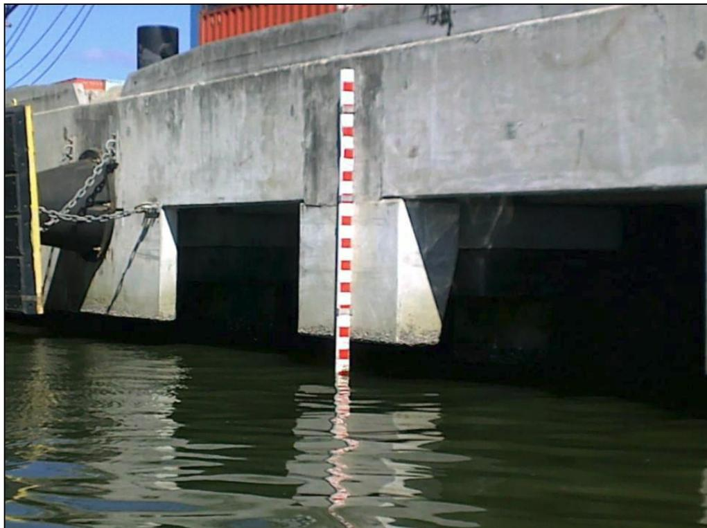
**Figura 3.3 – Régua maregráfica utilizada para leitura da variação da maré, necessária para nivelamento dos dados batimétricos**
