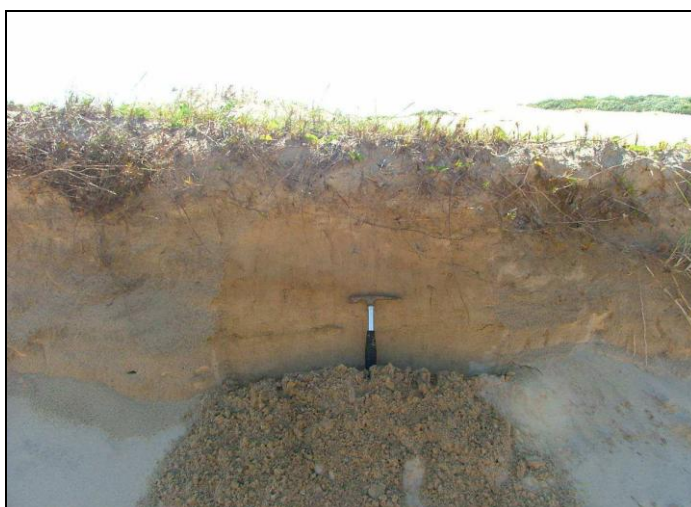
Figura 5.16 - Areias quartzosas de coloração amarelo claro à acastanhada. Praia Grande, área de influência indireta (Fonte: CARUSO Jr, 2009).
