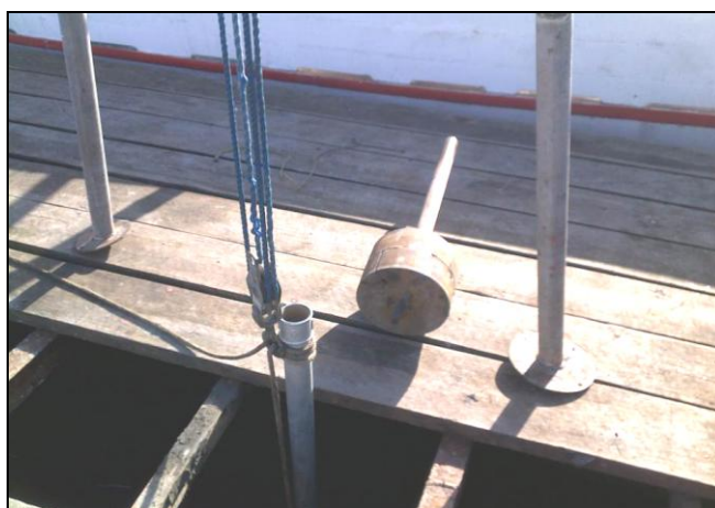
Figura 5.21 - Amostrador tubular de sedimentos de 2" de diâmetro e ao lado o peso utilizado para cravação do amostrador. (Fonte: SPECTRAH, 2011)
