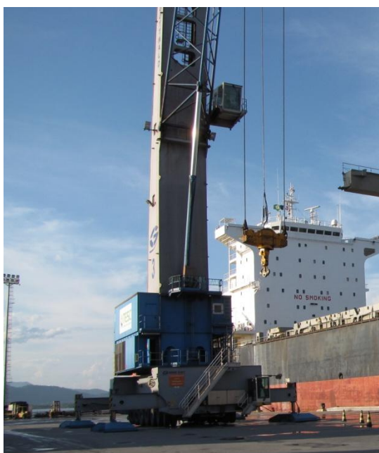
Figura 5.31 – Operação com guindastes MHC
