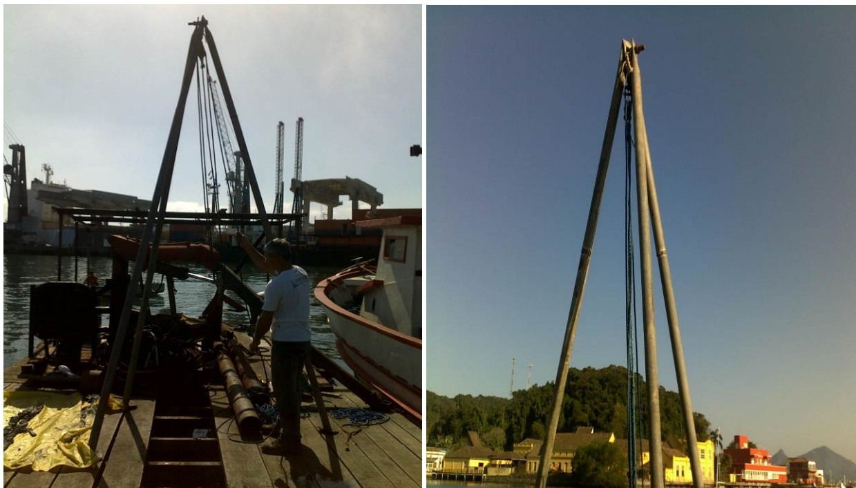
Figura 4. Balsa flutuante utilizada (esquerda) provida de tripé metálico (direita).
