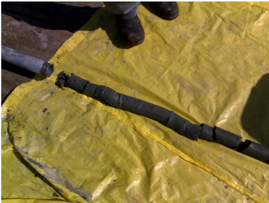
Figura 10. Testemunho cilíndrico retirado do interior do amostrador.
