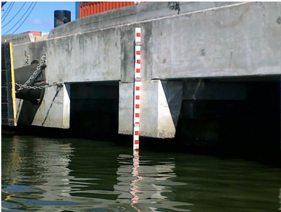
Figura 2. Régua maregráfica utilizada para leitura da variação da maré, necessária para nivelamento dos dados batimétricos
