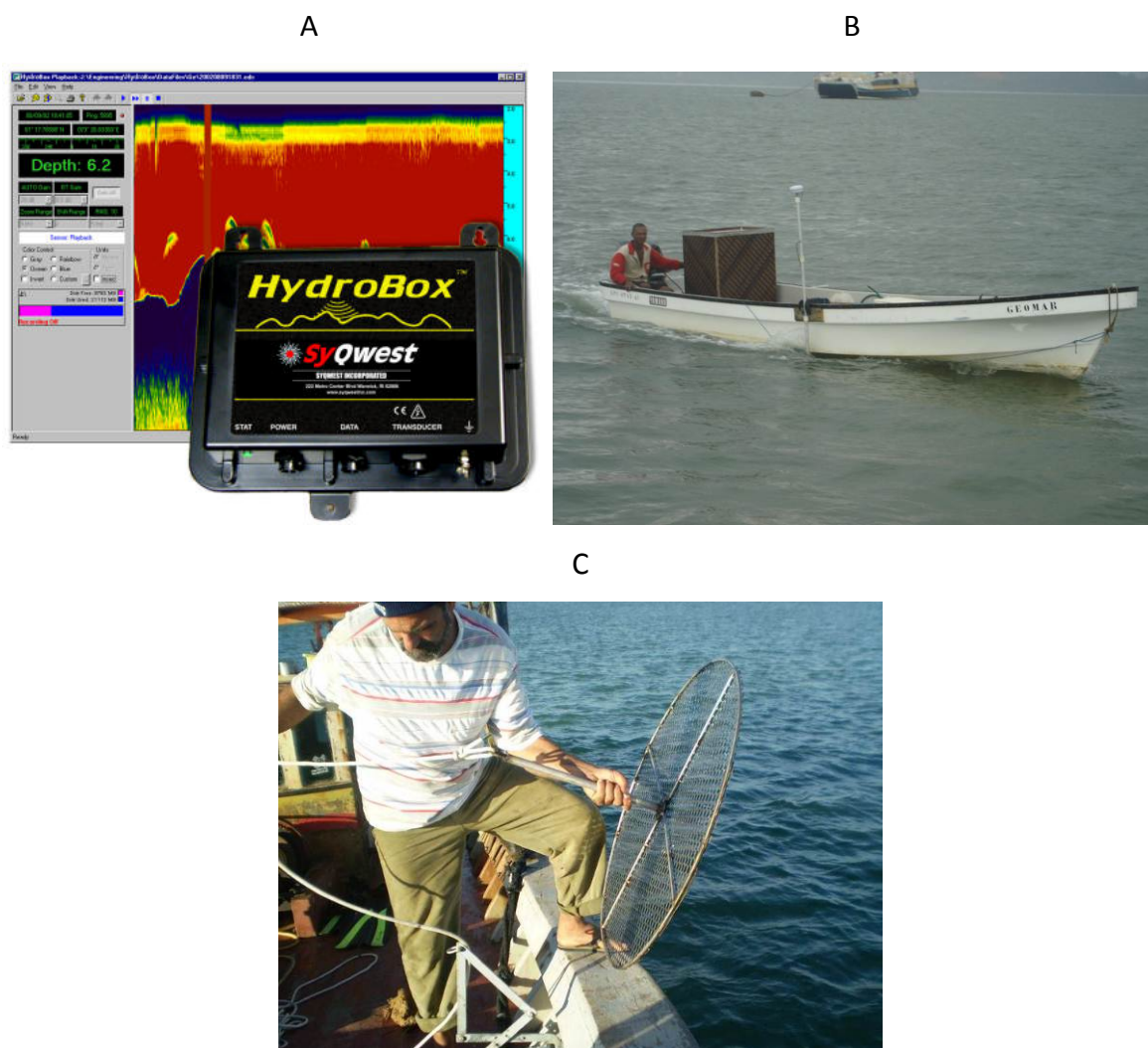
Figura 1. Ecobatímetro (A) Embarcação (B) e placa de calibração (C) para batimetria.
