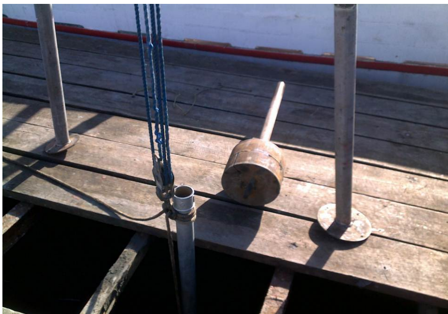
Figura 5. Amostrador tubular de sedimentos de 2" de diâmetro e ao lado o peso.
