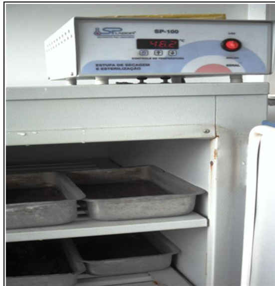
Figura 128. Estufa utilizada para a secagem dos sedimentos.
