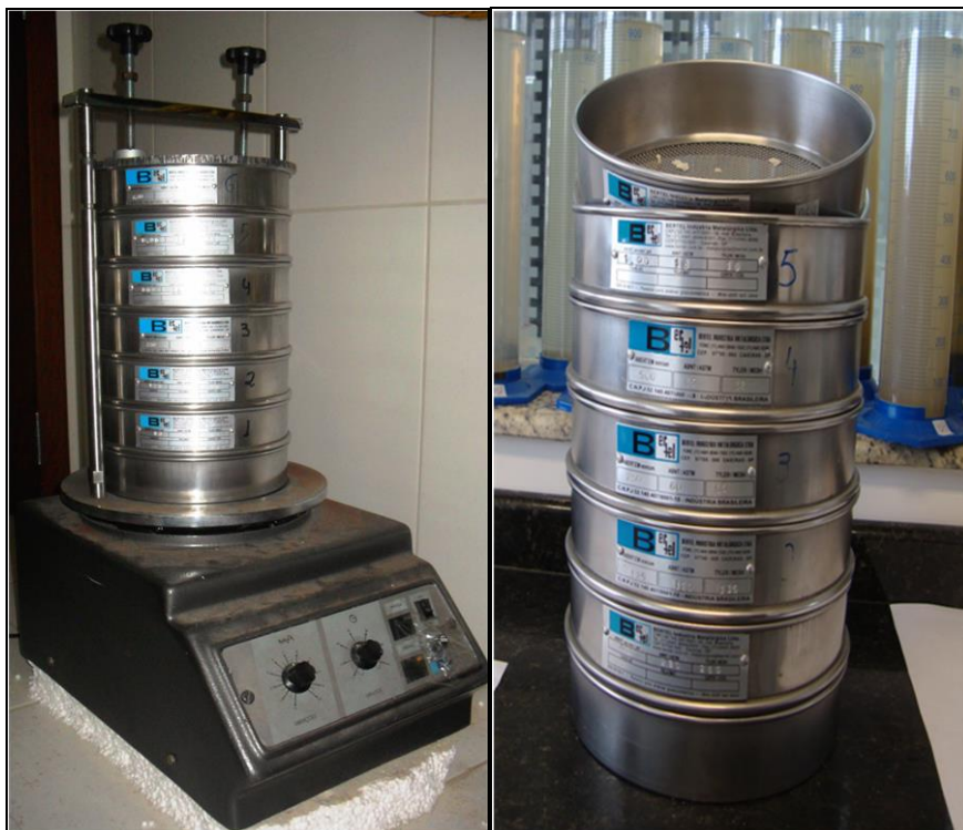
Figura 129. Agitador e peneiras utilizadas para o peneiramento, etapa da análise granulométrica.
