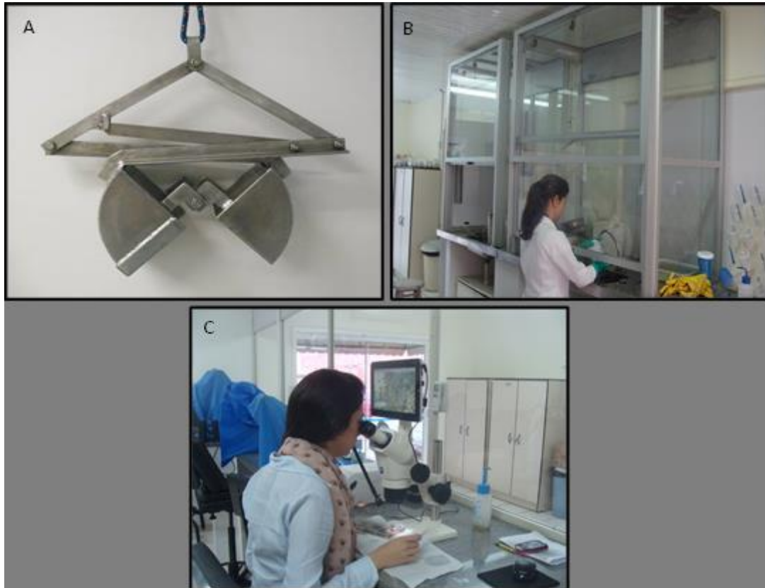
Figura 425. A: Busca fundo tipo van Veen utilizado para coleta da macrofauna bêntica; B: Triagem em jogo de peneiras de malha de 1 mm e 0,5 mm e C: Identificação em microscópio estereoscópio.
