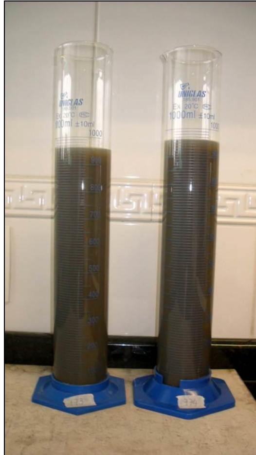
Figura 130. Método de pipetagem, utilizado para determinar o tamanho dos grãos nas frações lamosas.
