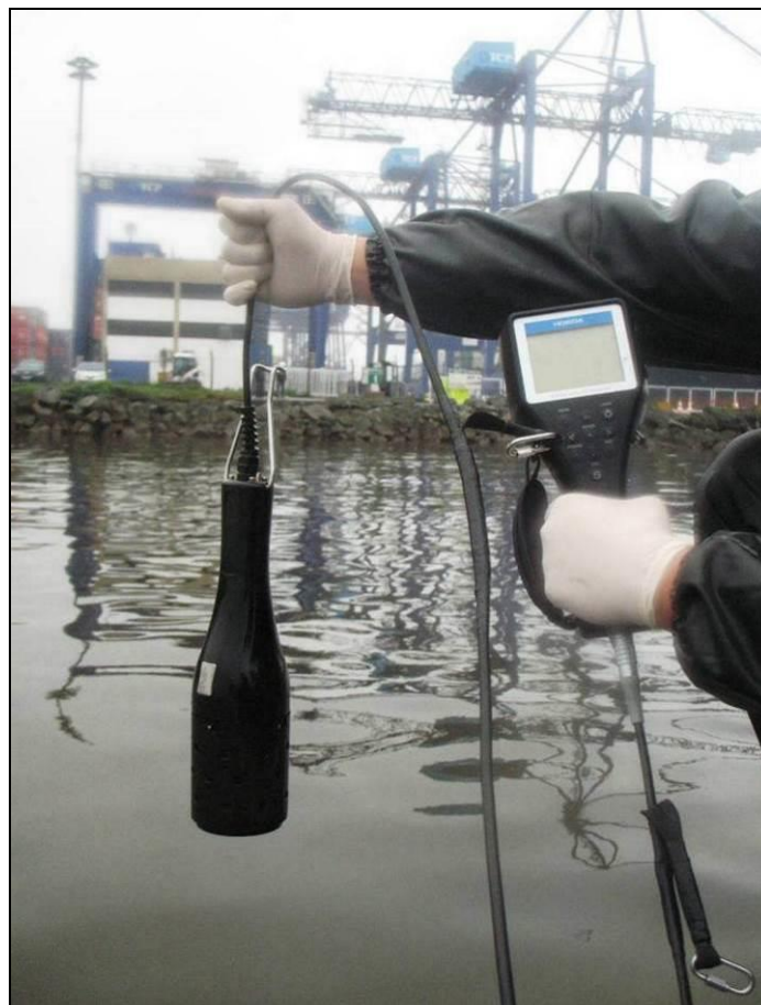
Figura 169. Sonda multiparamétrica marca Horiba, modelo U50, sendo utilizada na mensuração in situ dos parâmetros físico-químicos.
