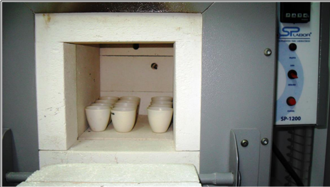
Figura 131. Forno mufla, utilizado para a determinação de matéria orgânica e carbonatos.
