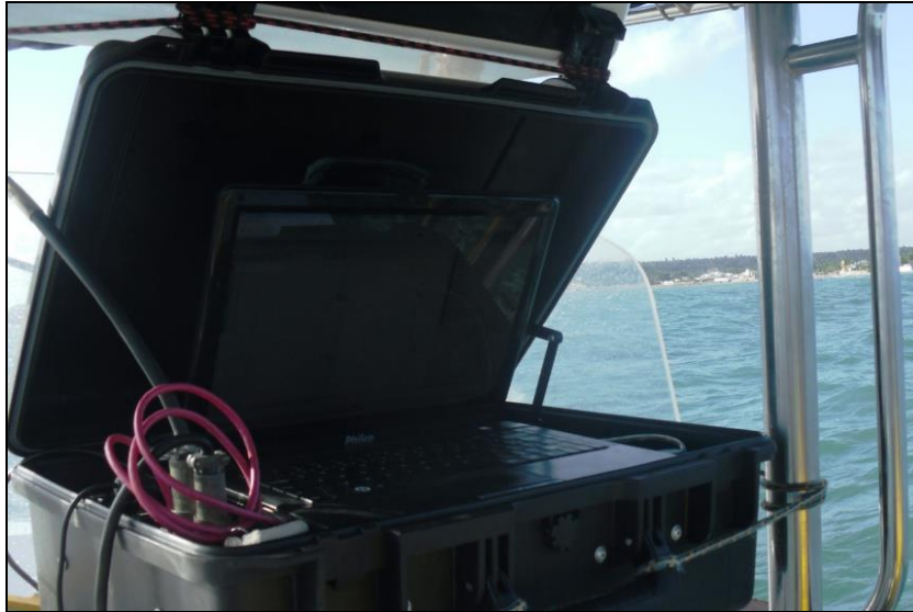
Figura 144. Ecobatímetro ODOM/ECHOTRAC™ instalado na embarcação - com microcomputador que permite a navegação e o registro dos dados.
