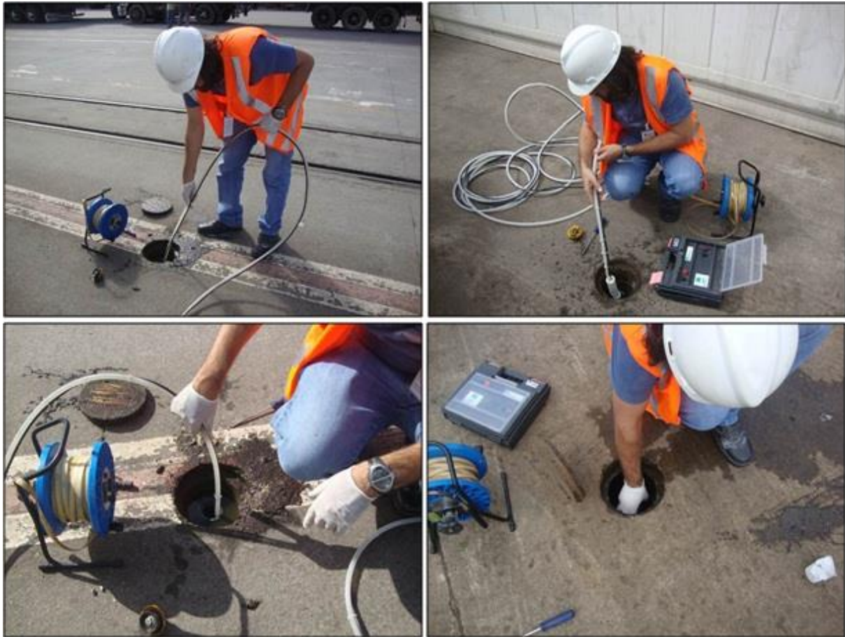
Figura 61. Procedimento de amostragem de água subterrânea nos poços de monitoramento do TCP, campanha de agosto de 2012.
