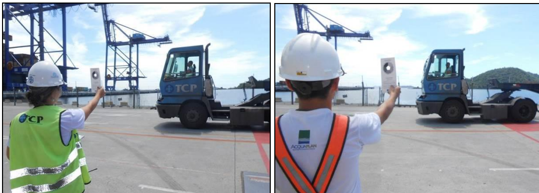
Figura 38. Monitoramento de fontes móveis, utilizando a Escala de Ringelmann.
