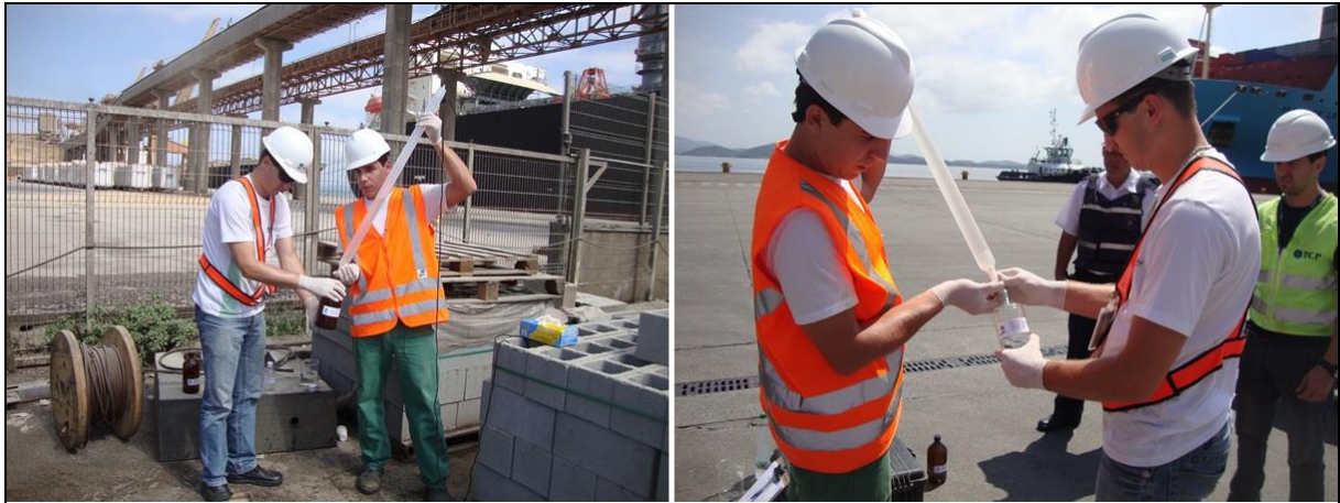
Figura 69. Procedimento de coleta da amostra de água subterrânea.
