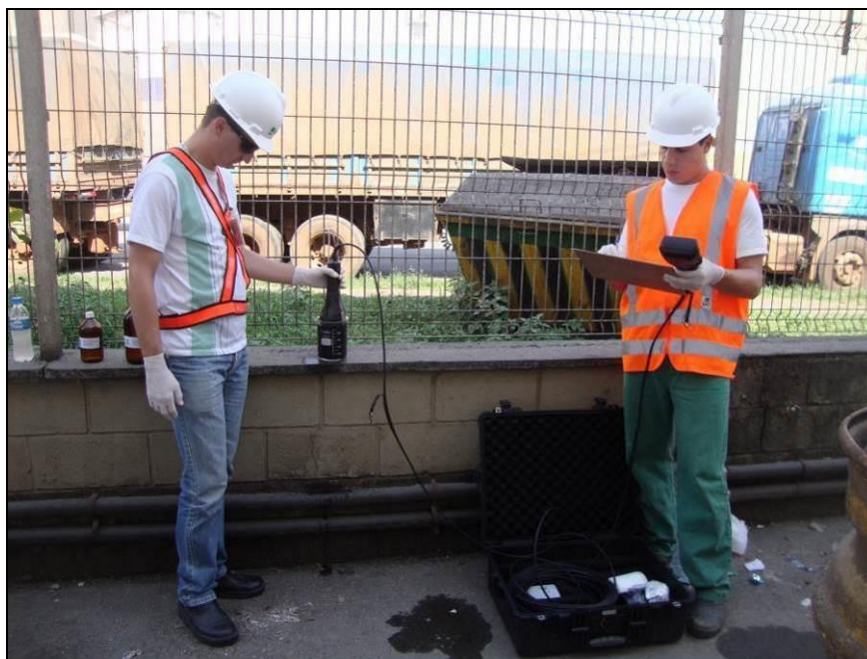
Figura 68. Medição de parâmetros in situ realizada através da sonda multiparâmetros HORIBA U-50.
