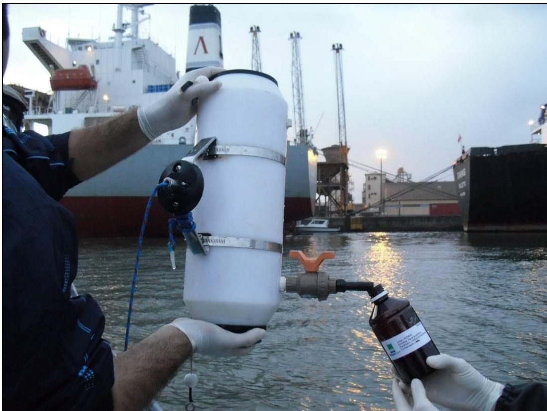
Figura 108. Amostras de água coletada com garrafa amostradora tipo van Dorn sendo acondicionada em frasco de vidro âmbar.
