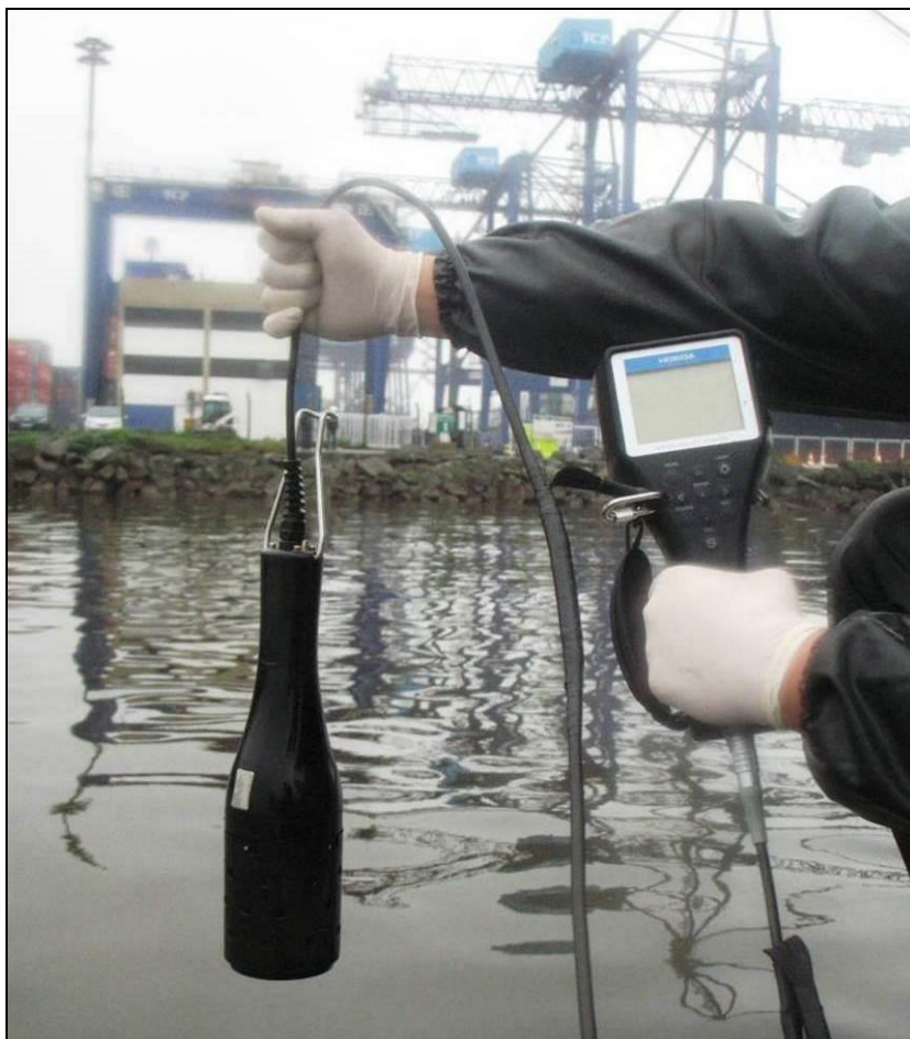
Figura 109. Sonda multiparamétrica marca Horiba, modelo U50, sendo utilizada na mensuração in situ dos parâmetros físico-químicos.
