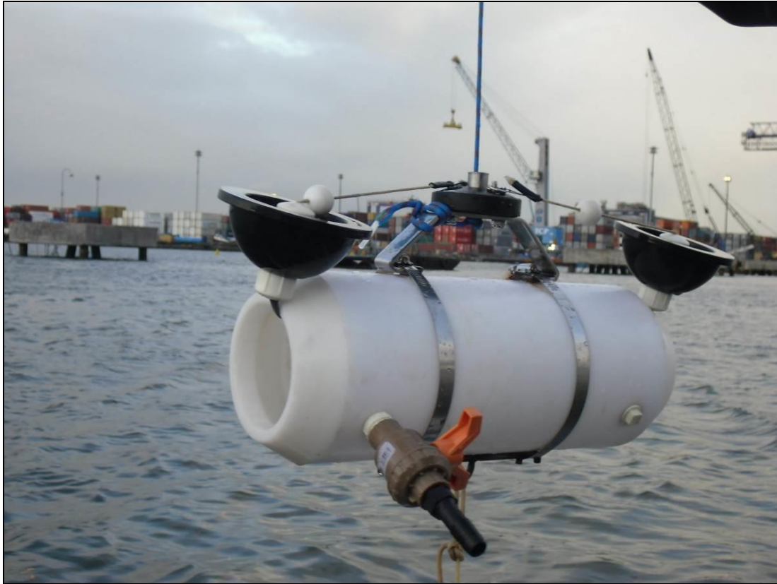
Figura 107. Garrafa van Dorn utilizada para coleta das amostras de água.
