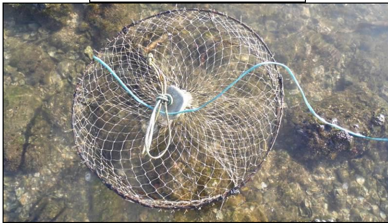
Figura 489. Sonda multiparâmetros e gaiola utilizada para coleta dos decápodes.
