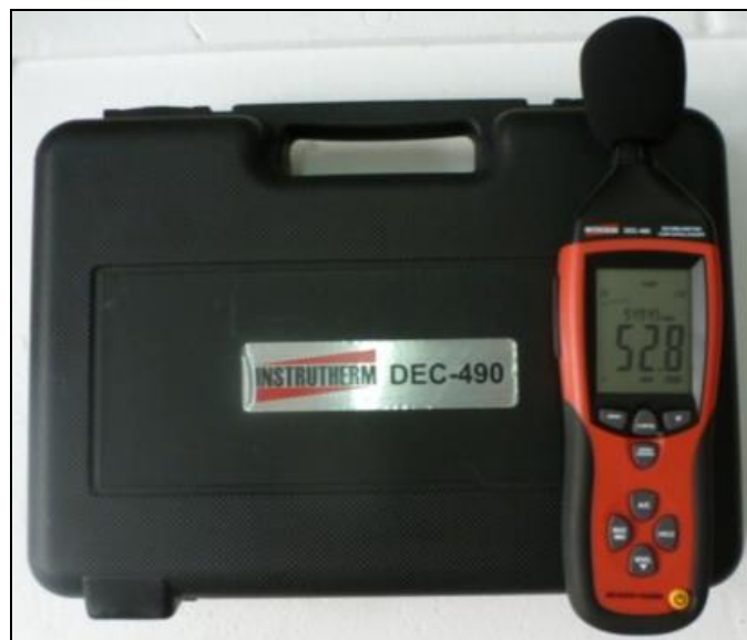
Figura 41. Medidor de nível de pressão sonora (decibelímetro) da marca Instrutherm, modelo DEC - 490 Digital.
