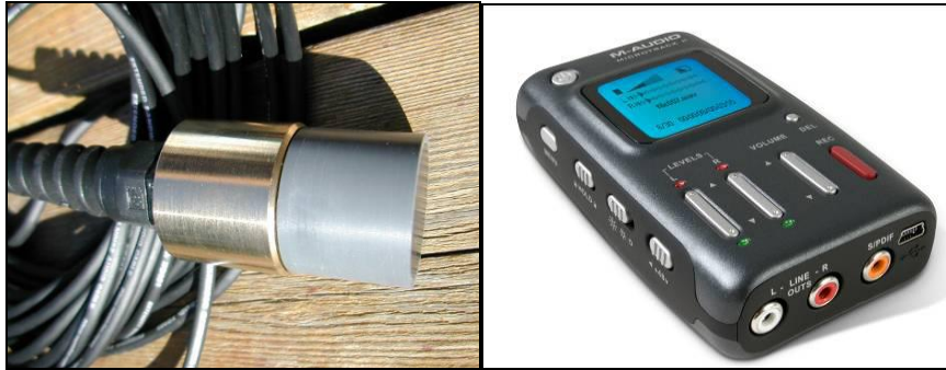
Figura 552. A esquerda o Hidrofone Cetacean Research SQ26-08 , e a direita o gravador digital M-Audio Microtrack II , utilizados para a coleta de dados de acústica na baía de Paranaguá (PR).
