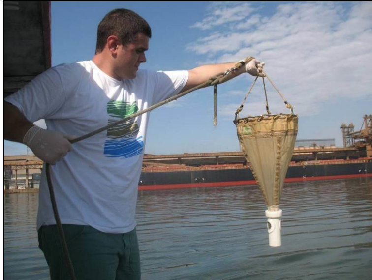
Figura 170. Rede cônica com malha de 20 µm utilizada para amostragem qualitativa de fitoplâncton na região amostral P#04.
