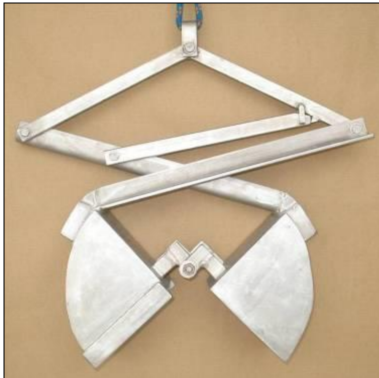
Figura 127. Amostrador do tipo van Veen utilizado para coleta de sedimentos superficiais.
