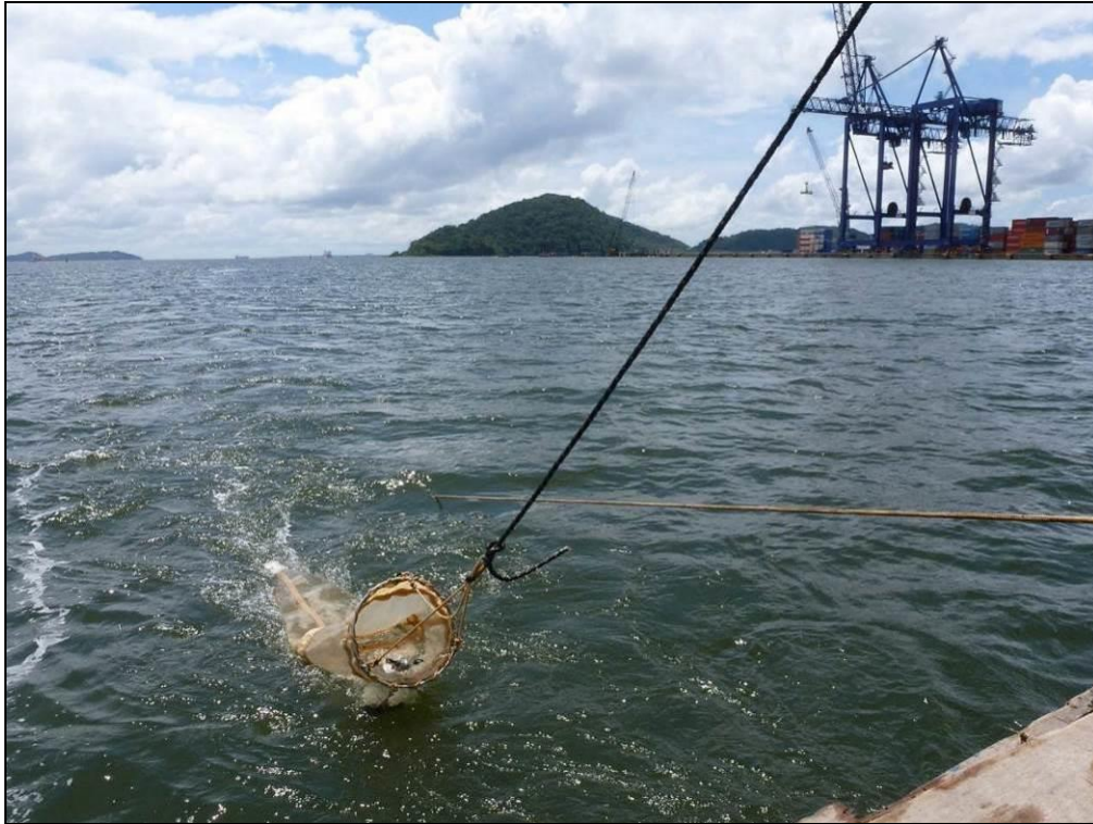
Figura 335. Arrasto da rede ictioplanctônica acoplada com fluxômetro para medir o volume de água filtrado.
