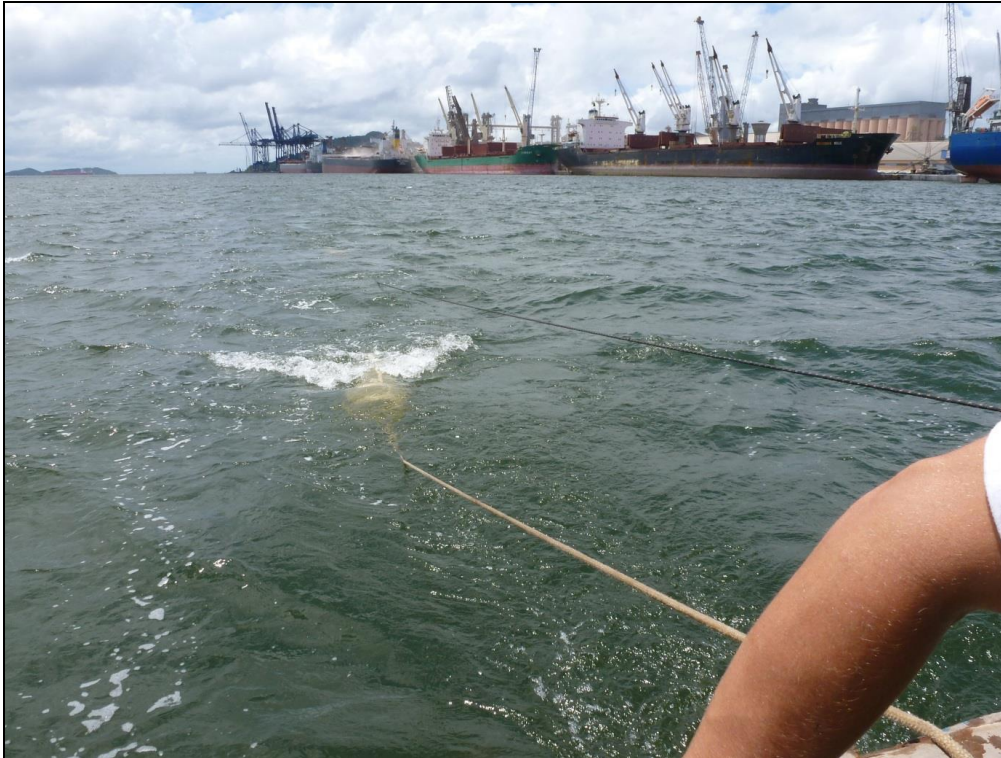
Figura 247. Rede para coleta de zooplâncton sendo arrastada em velocidade de 2 nós.
