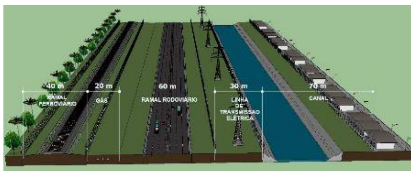
Figura 124 – Ilustração do projeto da faixa de infraestrutura. Fonte: Agência de Notícias do Paraná, 10/03/2014.
