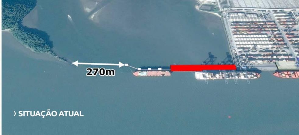
Figura 6. Ampliação do cais leste com a diminuição da seção livre do canal da Cotinga para 270 metros. (Situação atual)
