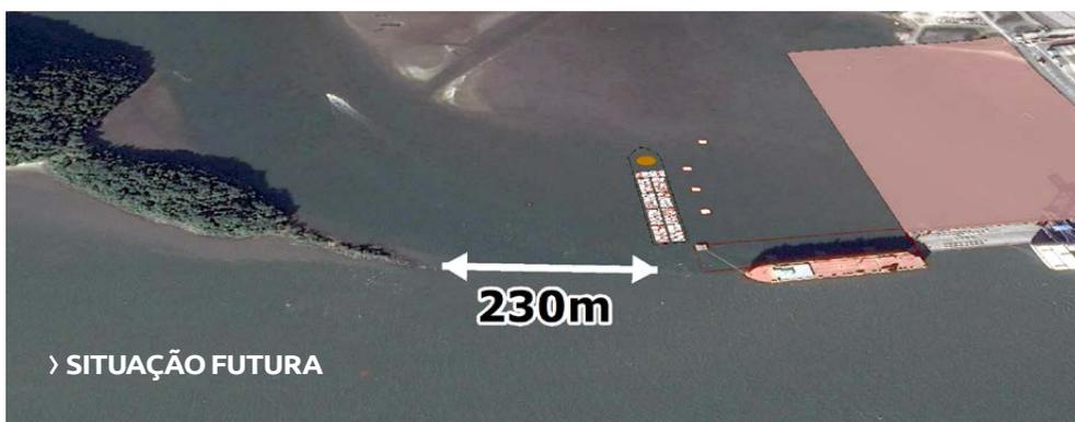
Figura 8. Seção livre do canal da Cotinga com 230 metros. Observa-se o navio atracado nos novos dolphins, oportunidade que haverá uma redução de 40 metros na seção do canal com atracação de um navio rol-on-roll-off. (Situação futura)
