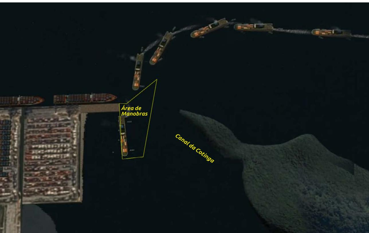
Figura 9. Simulação de manobra de entrada e atracação do navio de veículos e delimitação da área necessária para realização desta manobra.
