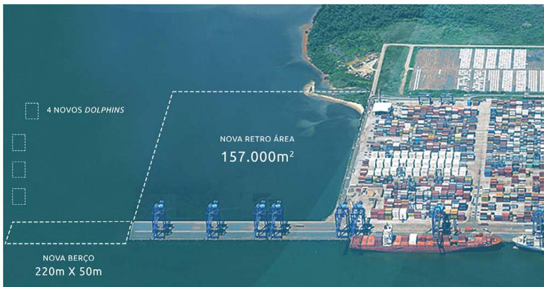
Figura 1. Espacialização das obras projetadas para a ampliação da TCP – Terminal de Contêineres de Paranaguá.
