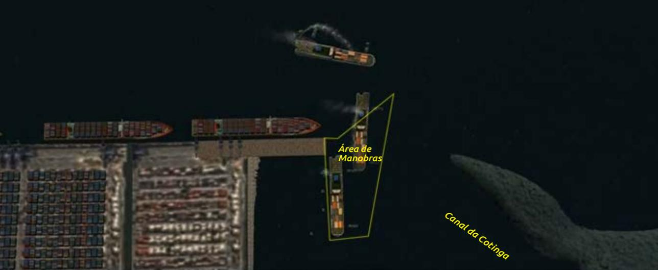
Figura 10. Simulação de manobra de saída e desatracação do navio de veículos e delimitação da área necessária para realização desta manobra.
