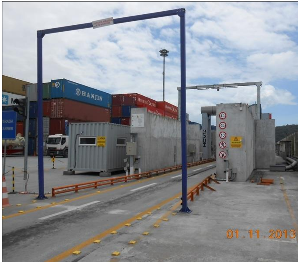
Figura 33. Scanner para os caminhões contêineres.
