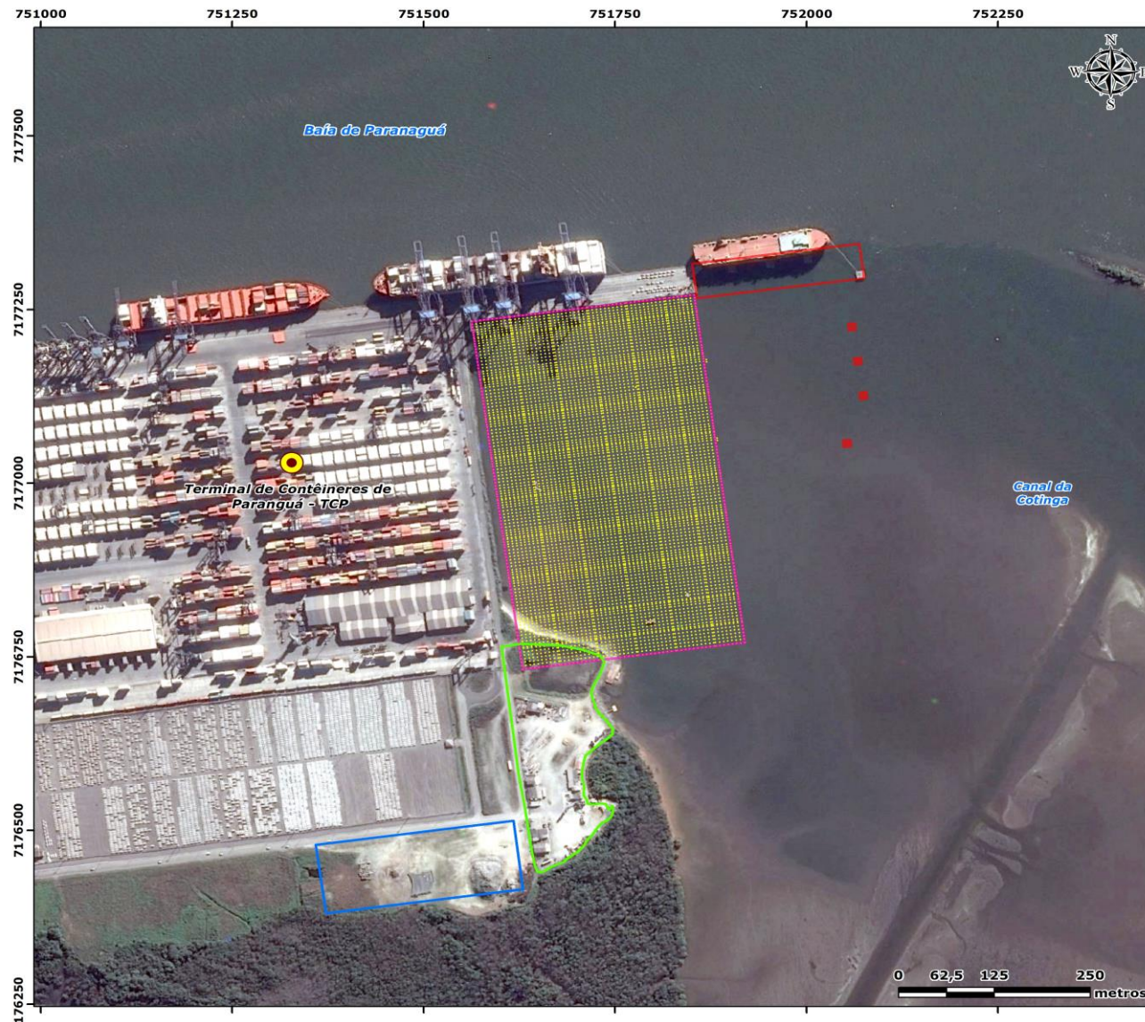
Figura 12. Layout do projeto de ampliação do Terminal de Contêineres de Paranaguá - TCP, Município de Paranaguá, Paraná.
