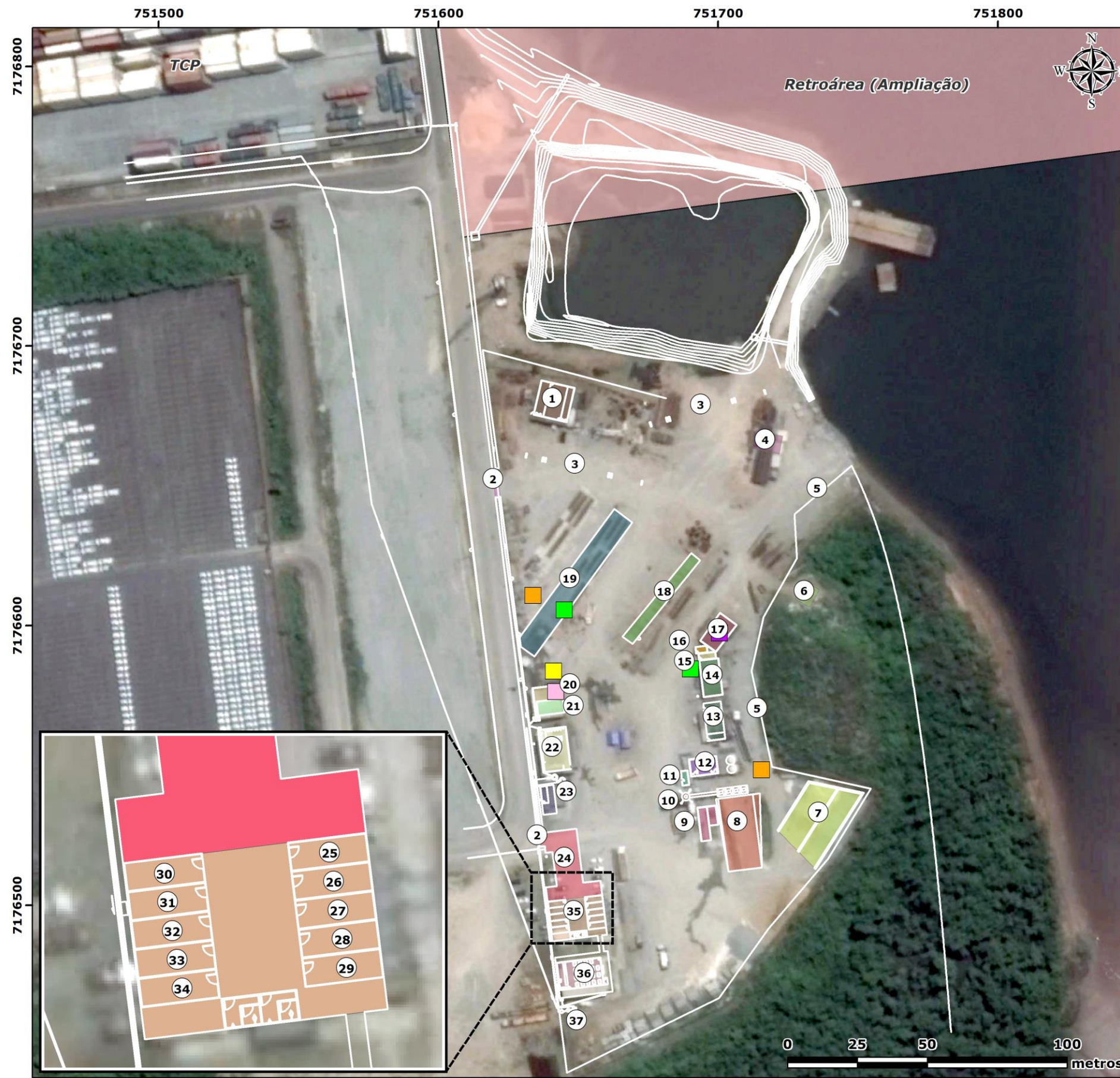
Figura 11. Layout do Canteiro de Obras da Complementação da Ampliação da TCP com identificação dos locais para armazenamento temporário de resíduos.
