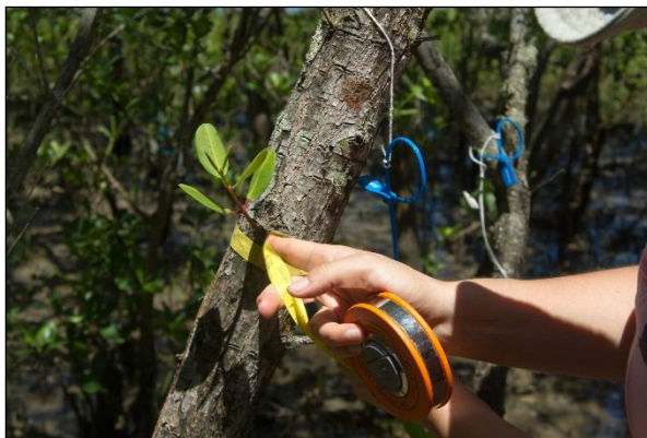
Figura 3. Trena graduada utilizada para aferição do diâmetro dos troncos e telêmetro óptico utilizado para aferição de altura dos indivíduos.
