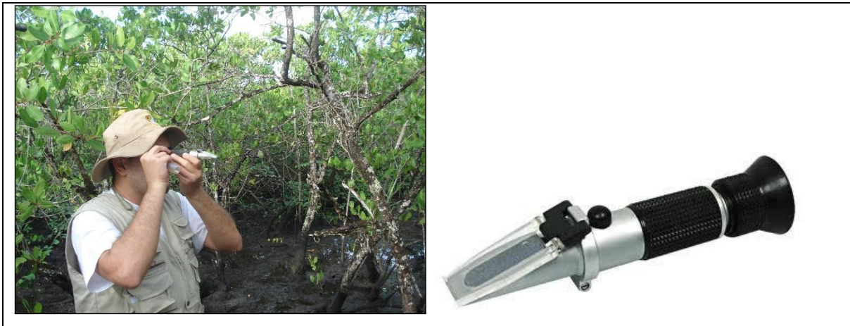
Figura 4. Uso de refratômetro óptico para aferição da salinidade da água intersticial.
