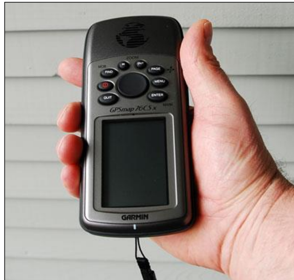
Figura 2. Equipamento de navegação ( Global Position System ) utilizado para marcação das parcelas.
