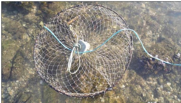
Figura 2. Sonda multiparâmetros e gaiola utilizada para coleta dos decápodes.
