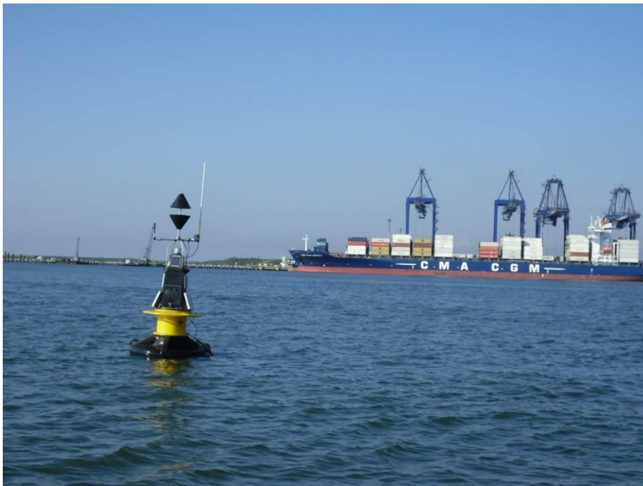
Figura 10. Visão da boia aonde está instalado o perfilador de correntes acústico AWAC®, em frente ao cais do TCP.
