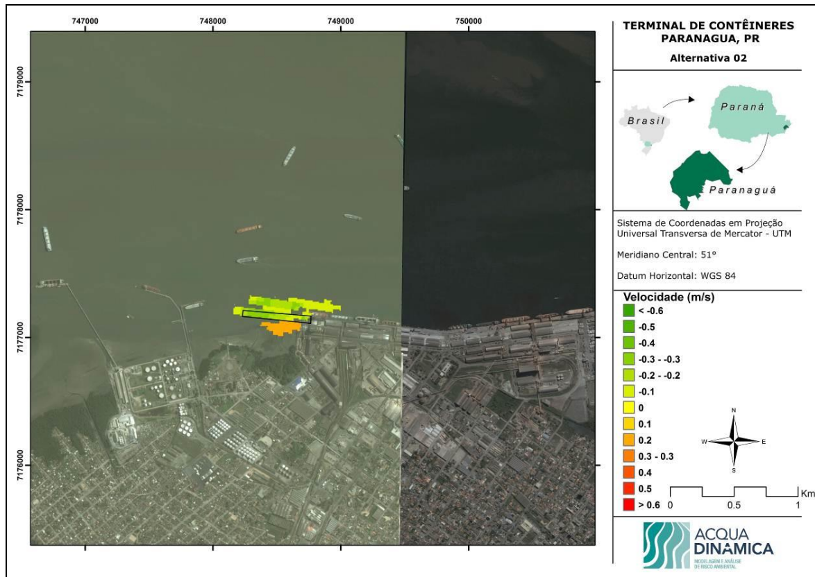
Figura 27. Variação na velocidade na área adjacente ao Terminal de Contêineres de Paranaguá - TCP, para a maré vazante em sizígia do Cenário 02 .
