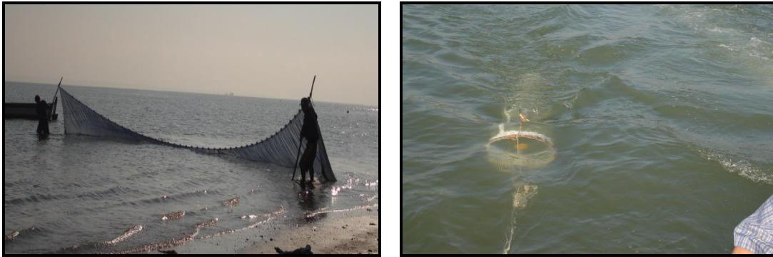
Figura 164 – Amostradores utilizados nas áreas de influência ADA, AID e AII: a) rede tipo picaré para a coleta de fases larvais e juvenis; b) rede de ictioplâncton para a coleta de ovos e larvas.
