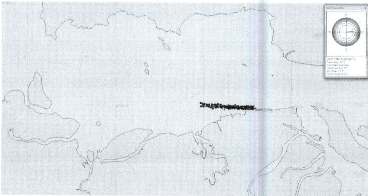
Figura 18 – Resultado da simulação determinística de pior caso para o período de verão, após 2 horas do início do vazamento. Fonte: PEI.
