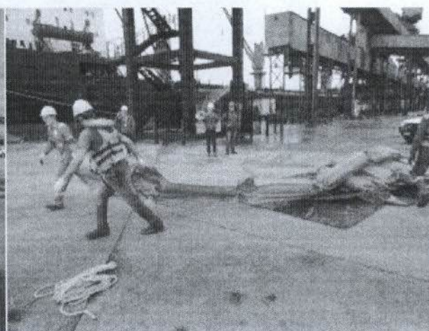
Figura 15 – Preparação da barreira de contenção para lançamento na água.
