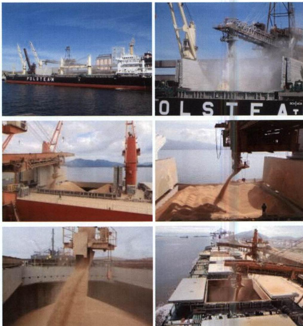
Diagnóstico: Com base nos registros fotográficos e nas vistorias em campo, foram detectadas que durante as operações de carregamento de granéis sólidos vegetais, sob condições de vento adversas, existem emissões fugitivas.
