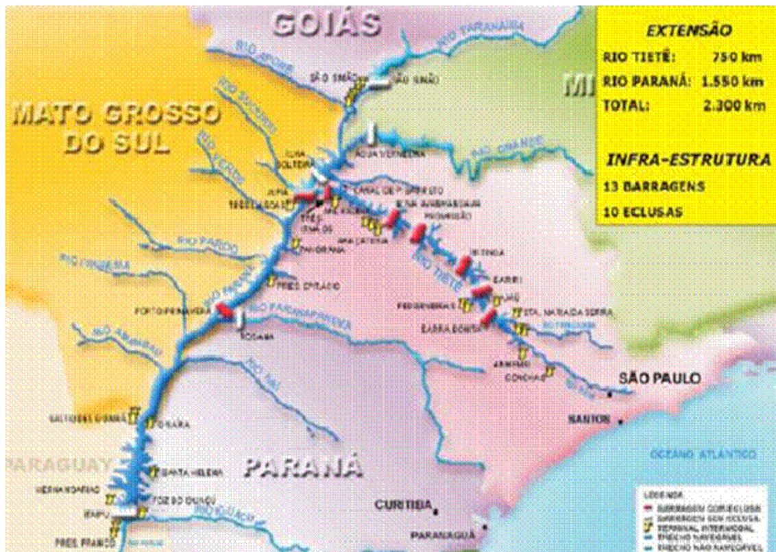
Figura 4.3.2.21.7.1-1: Hidrovia Tietê-Paraná. Sistema logístico de escoamento de grãos agrícolas da Caramuru (Fonte: Navegação Fluvial no Estado de São Paulo - Revista Engenharia in Louis Berger Group/Internave Engenharia, 2009).
