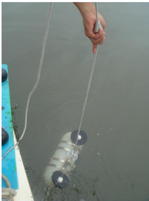
Figura 4.2.3.2.3-2: Garrafa Van Dorn com capacidade de 5 litros e 4 Kg de lastro.
