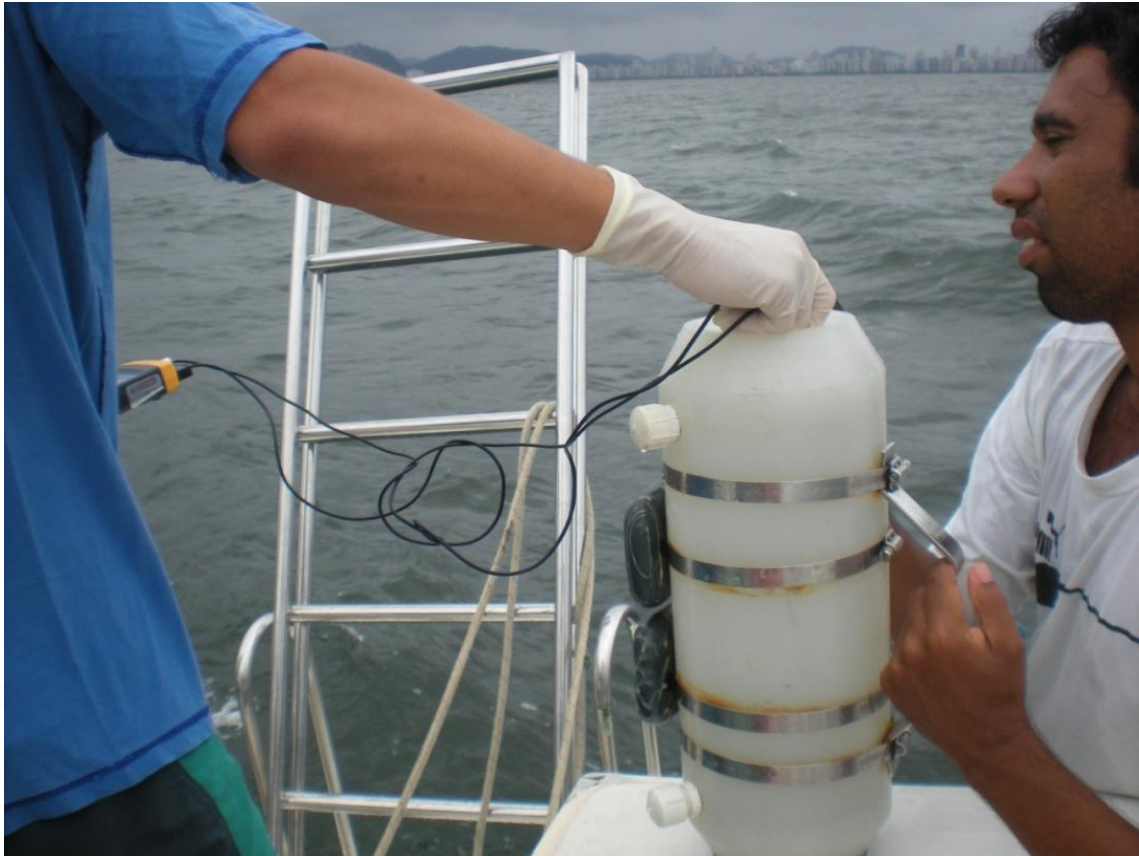
Figura 4.2.3.2.3-5: Analisador PH 1500 utilizado para obtenção dos valores de temperatura, pH e oxigênio dissolvido da água coletada pela garrafa Van Dorn.
