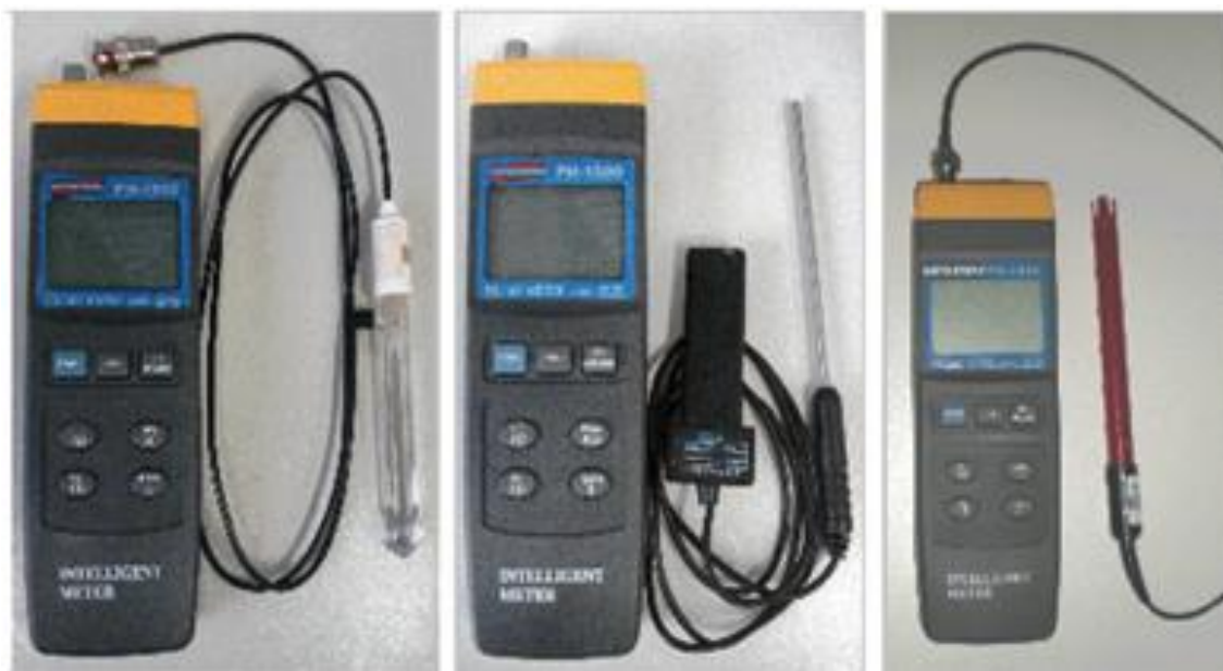
Figura 4.2.3.1.1-3: Analizador PH 1500 utilizada para obtenção dos valores de temperatura, pH e ORP do sedimento.
