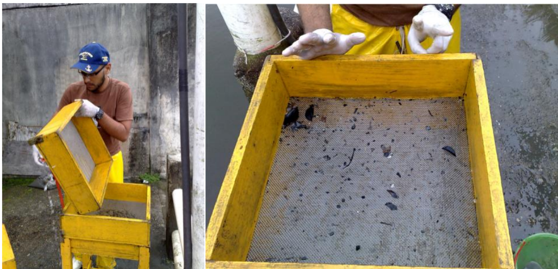
Figura 4.2.3.1.1-5: Lavagem do sedimento.
