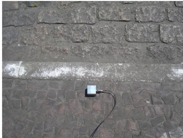
**Figura 4.1.9.2-3: Acelerômetro fixado no pod metálico no eixo y.**
