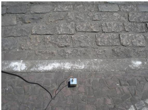
**Figura 4.1.9.2-1: Acelerômetro fixado *pod* metálico no eixo z.**
