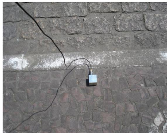
**Figura 4.1.9.2-2: Acelerômetro fixado no *pod* metálico no eixo x**
