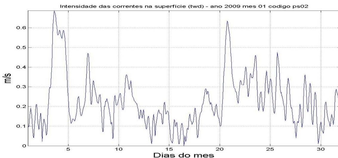
Figura 4.1.7.3-2: Intensidade da corrente na superfície, calculada pelo modelo numérico hidrodinâmico, para o mês de janeiro de 2009, no ponto selecionado 2 da grade da plataforma.
