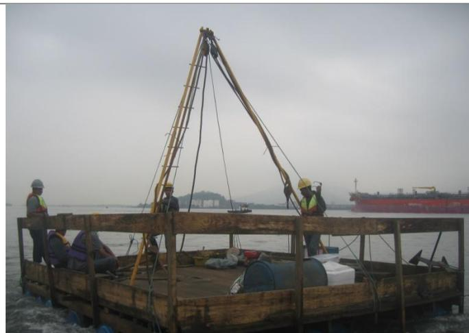
Figura 6. Plataforma utilizada na coleta de sedimento de subsuperfície.
