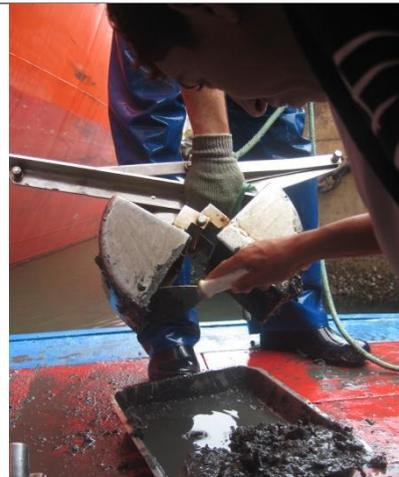
Figura 2. Coleta de sedimento de superfície com amostrador *van Veen*.
