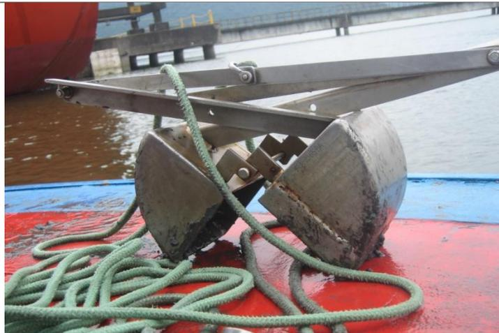
Figura 1. Amostrador *van Veen* para coleta de sedimento de superfície.
